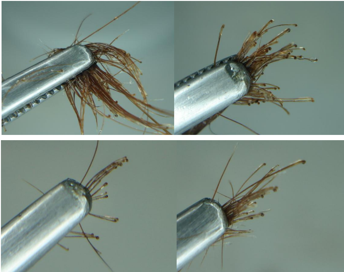
Figura 15: Pelos inteiros removidos pelo processo enzimático-oxidativo de depilação. Etapa enzimática: enzimas produzidas pela linhagem BLBc 11.
