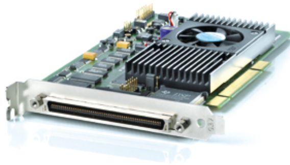
Figura 35: Placa de Aquisição e Transmissão de Dados dSPACE . Figura retirada do seguinte endereço: http://www.dspace.com/en/pub/home/products/hw/singbord/ds1104.cfm .
