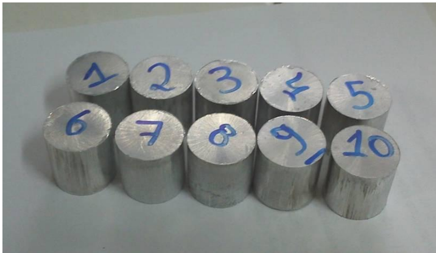
Figura 37 - Amostras compactadas (verde) com 21mm diâmetro e 22mm de altura.
