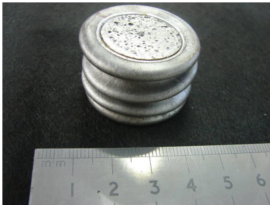
Figura 44 - Exemplo de amostra de tubo preenchido com espuma após ensaio de compressão.
