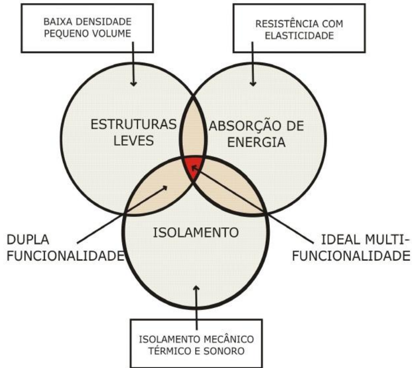
Figura 21 - Campos de aplicação da espuma metálica com função estrutural no setor automotivo 48 .
