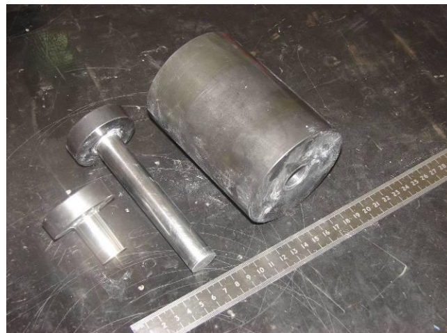
Figura 33 - Matriz cilíndrica utilizada na compactação das amostras de pó de Al-TiH 2 .
