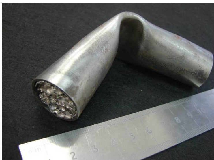
Figura 46 - Exemplo de amostra de tubo preenchido após ensaio de dobramento.
