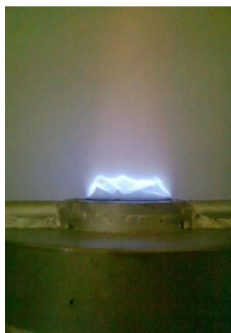
Figura 5.5 - Chama encontrada para razão próxima à estequiométrica
