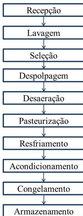
Figura 2.3 – Fluxograma simplificado do processamento de polpa de acerola pasteurizada congelada.
