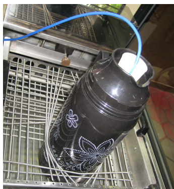
Figura 2.5 – Fotografia do calorímetro construído para execução dos experimentos.
