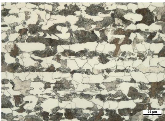
Figura 5-5 - Micrografia da matéria-prima, ataque Nital 2%, Corrida A.
