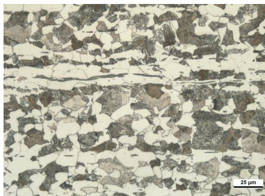
Figura 5-6 – Micrografia da matéria-prima, ataque Nital 2%, Corrida B.
