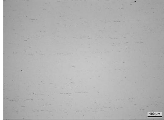
Figura 5-8 - Micrografia da matéria-prima, sem ataque, Corrida B.
