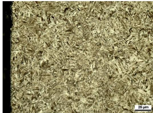
Figura 5-16 - Macrografia da amostra temperada por indução 1,1 mm, ataque Nital 2%.
