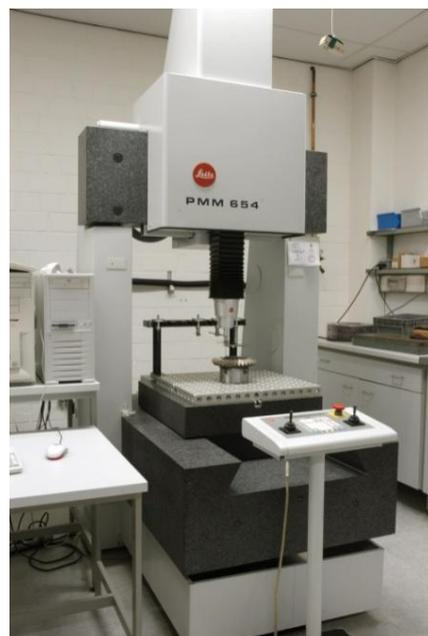
Figura 4-15 – Equipamento de medição tridimensional do IWT, Leitz modelo PMM 654.
