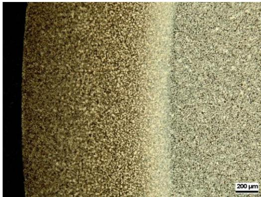
Figura 5-15 - Macrografia da amostra temperada por indução 1,1 mm, ataque Nital 2%.
