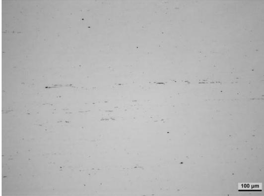
Figura 5-7 - Micrografia da matéria-prima, sem ataque, Corrida A.
