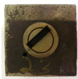
Figura 17: Vista superior da chapa após a retirada do corpo de prova por eletroerosão.
