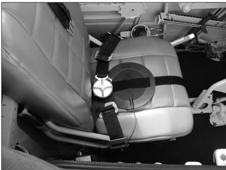
Figura 12 - Seat Pad Brüel & Kjær, instalado na interface de medição.
