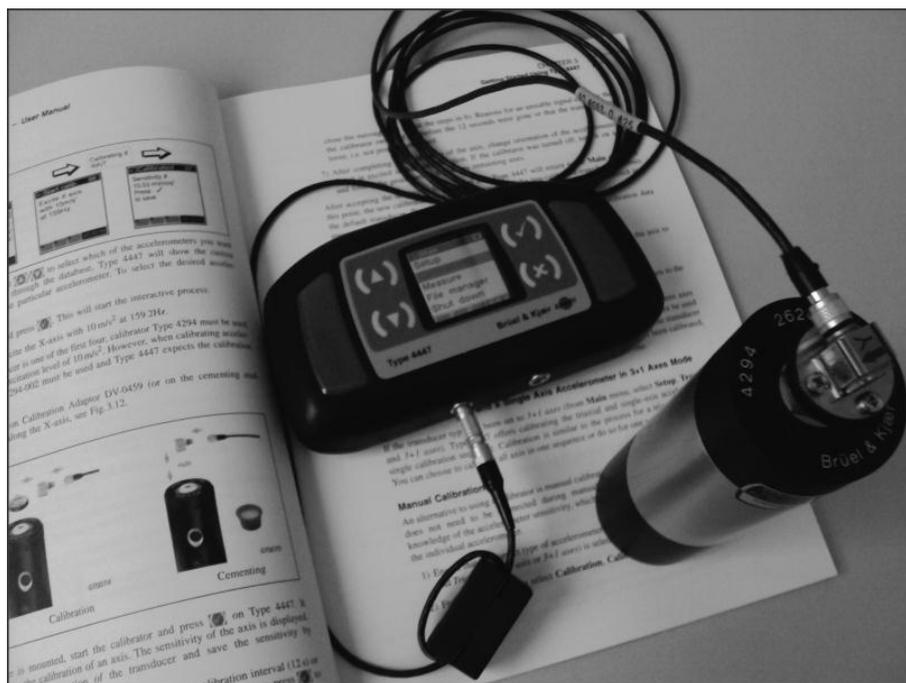
Figura 13 – Acelerômetro triaxial e calibrador.
