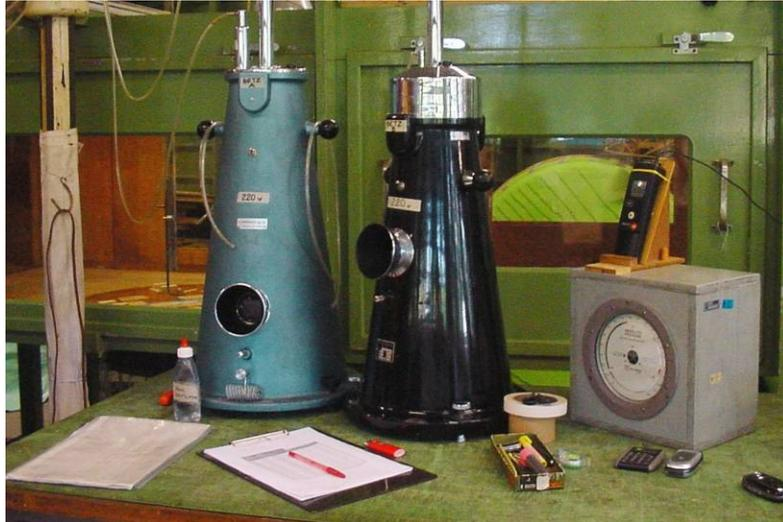
Figura 10: manômetros Betz, Barômetro e Termômetro utilizados anteriormente.
