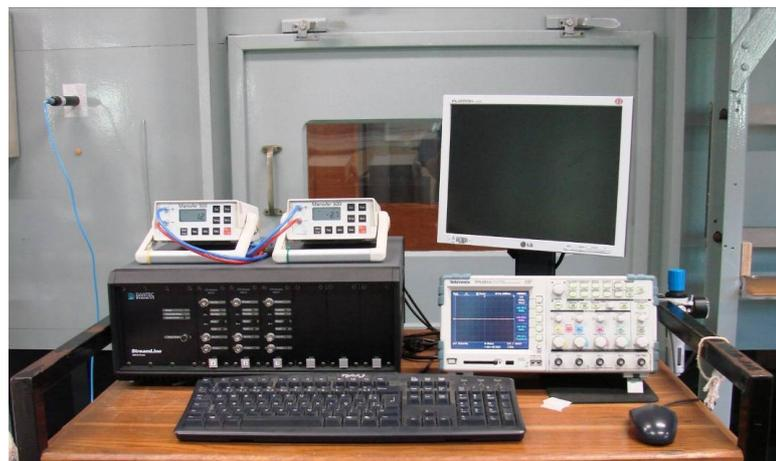
Figura 11: novo arranjo de instrumentação: 2 ManoAir-500 e 1 osciloscópio TPS-2014.
