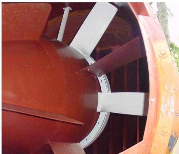
Figura 8: hélice e elementos aerodinâmicos.
