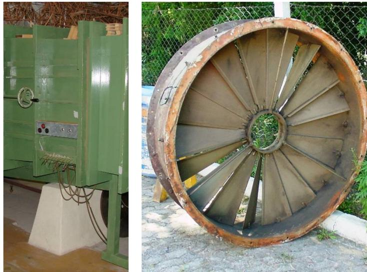
Figura 5: antigo controle de velocidade do ar: acionamento e aletas móveis.
