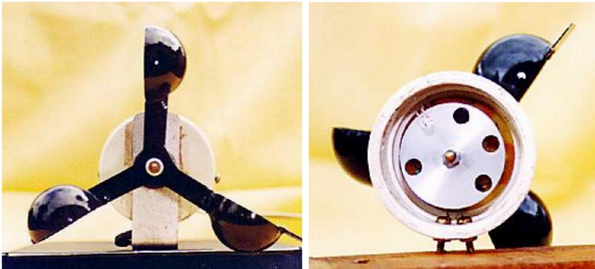
Figura 12: estrela de copos (e) e disco perfurado (d) de um anemômetro de conchas.
