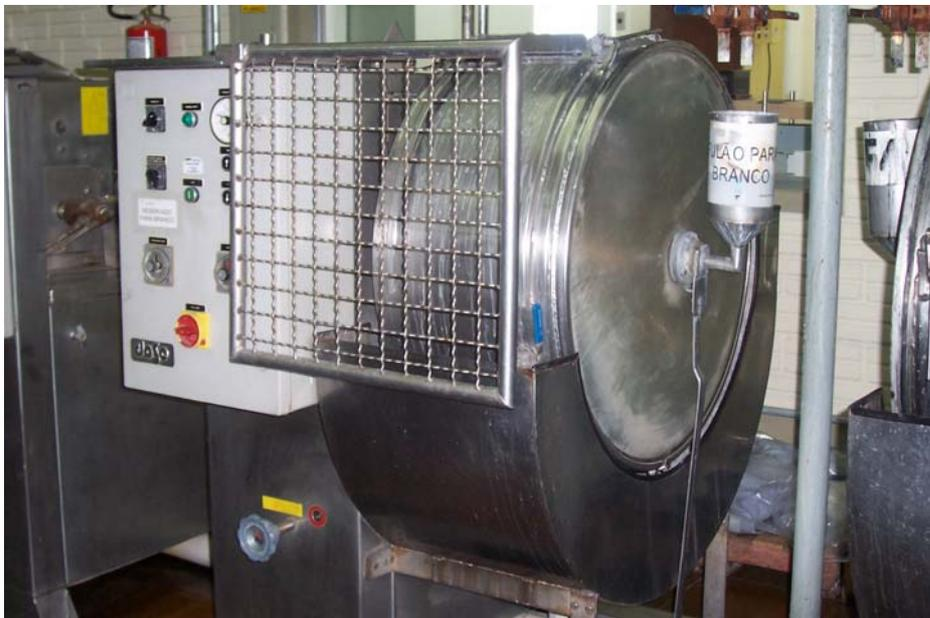
**Figura 5.1:** Fulão piloto utilizado no estudo das variáveis do processo
