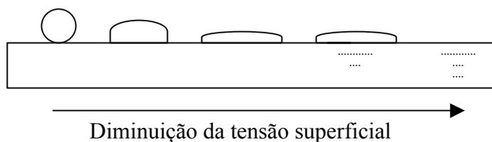
**Figura 2.10:** Comportamento de uma gota sobre um sólido, conforme diminui a tensão superficial
