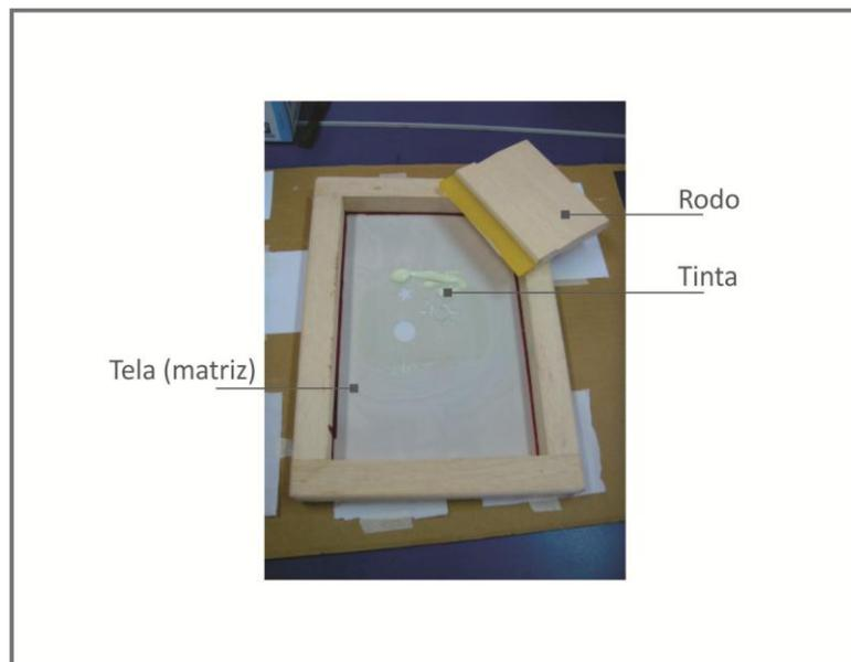
Figura 5: Equipamentos utilizados na impressão serigráfica: tela matriz de 55 fios, rodo e tinta
