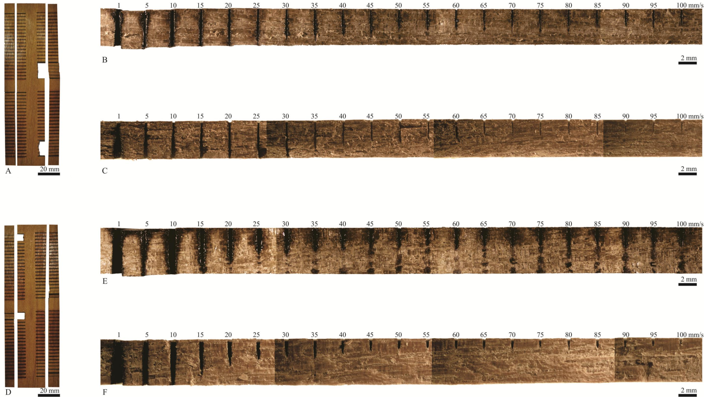
Figura 42 – Itaúba: ensaio com traços retos em amostras de 4 mm e 5 mm.
