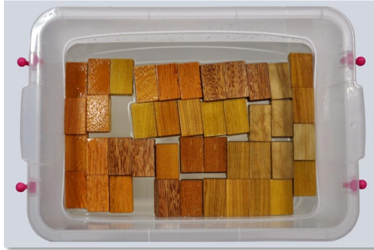
Figura 17 – Corpos de prova colocados em água.
