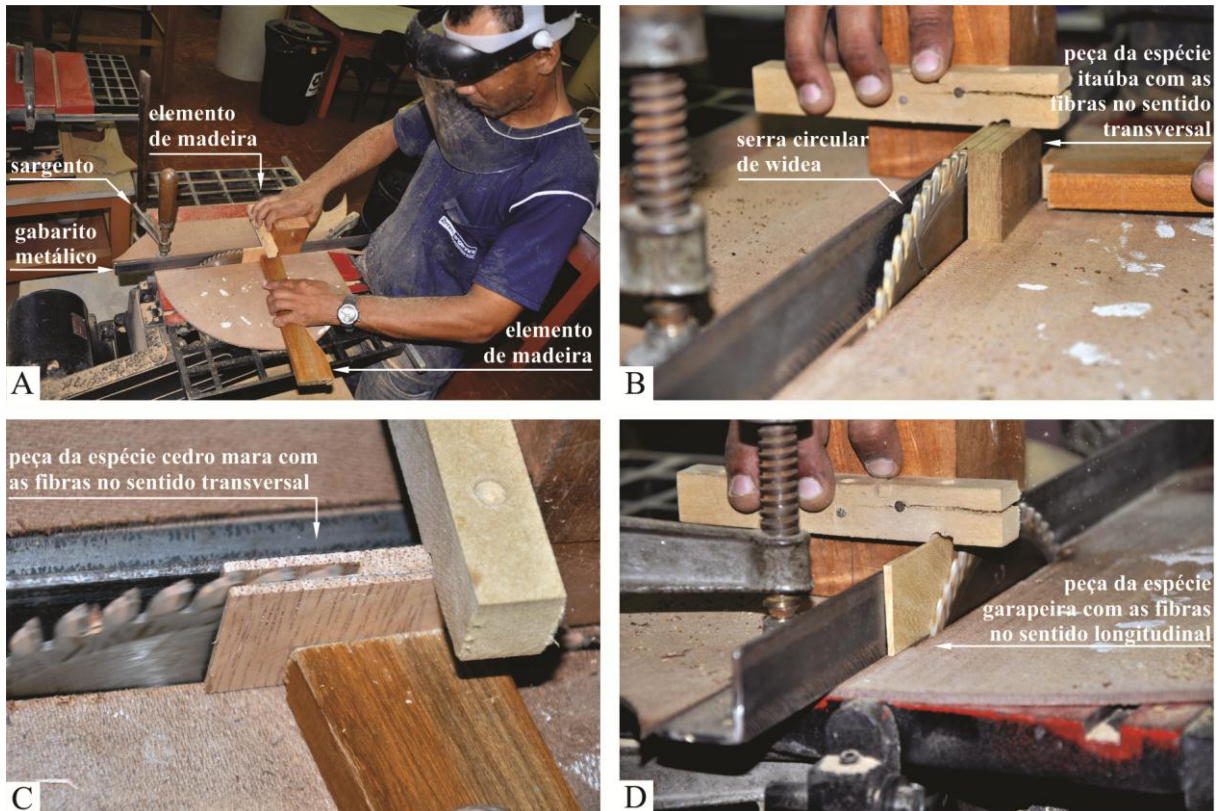
(A) Serra circular de bancada sendo utilizada para o corte da peça da espécie tauari (fibras no sentido transversal); (B) Peça da espécie itaúba sendo cortada (fibras no sentido transversal); (C) Peça da espécie cedro mara sendo cortada (fibras no sentido transversal); (D) Peça da espécie garapeira sendo cortada (fibras no sentido longitudinal).
