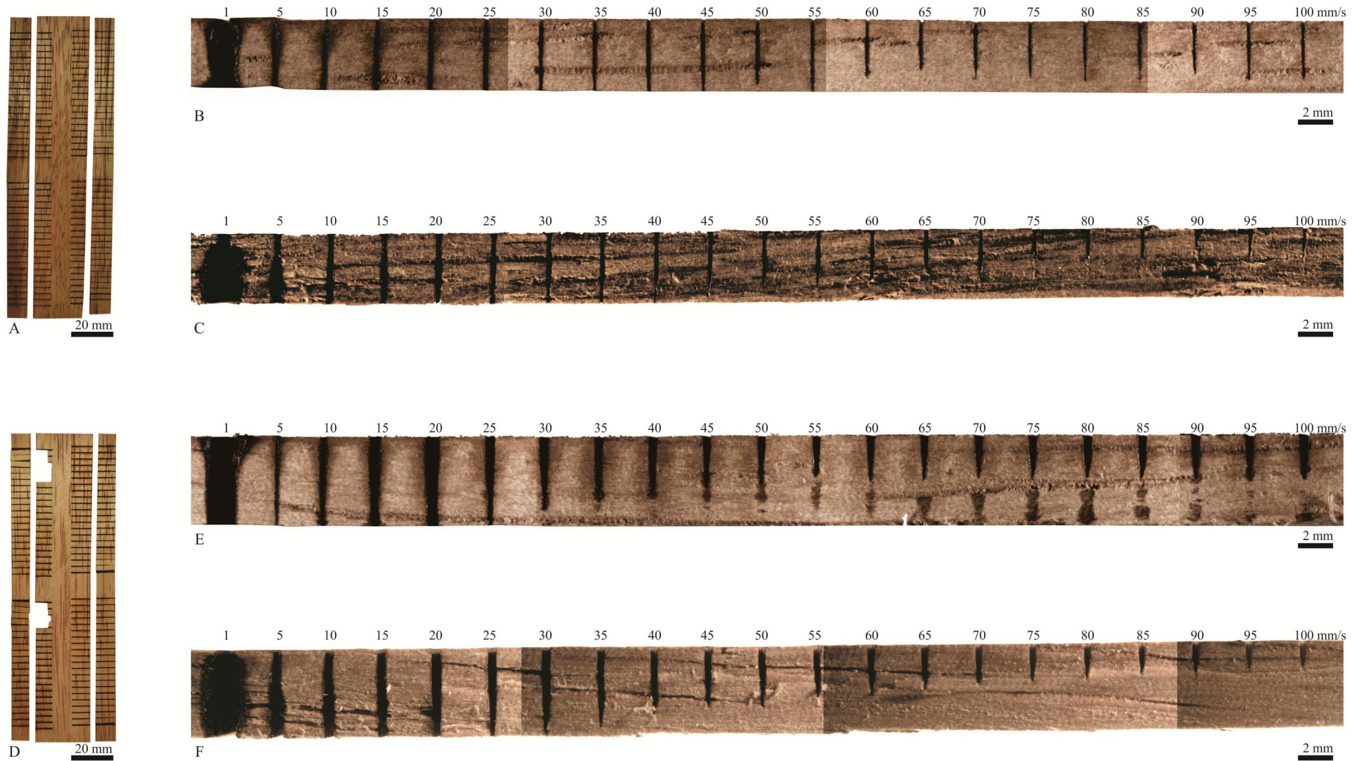
À esquerda, amostras após o ensaio de corte a laser com traços retos; e à direita, fotomontagem das imagens de microestereoscopia mostrando os resultados das diferentes velocidades testadas (1 a 100 mm/s), da esquerda para direita em ordem crescente. (A) amostra de 4 mm; (B) imagens de microestereoscopia da extremidade da amostra de 4 mm; (C) imagens de microestereoscopia do meio da amostra de 4 mm; (D) amostra de 5 mm; (E) imagens de microestereoscopia da extremidade da amostra de 5 mm; e (F) imagens de microestereoscopia do meio da amostra de 5 mm. Para ambas amostras, percebe-se que quanto maior a velocidade, menor a profundidade do corte.
