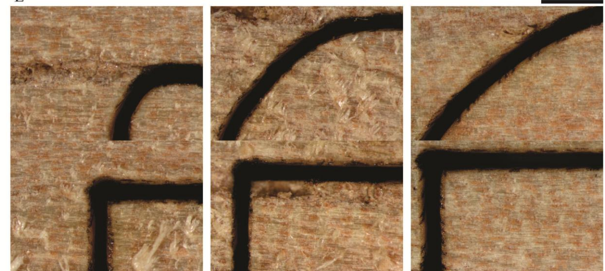
(A) Da esquerda para direita, amostras nas espessuras 5, 4, 3, 2 e 1 mm; (B) Imagens de microestereoscopia das amostras de 5 mm; (C) Imagens de microestereoscopia das amostras de 4 mm; (D) Imagens de microestereoscopia das amostras de 3 mm; (E) Imagens de microestereoscopia das amostras de 2 mm; (F) Imagens de microestereoscopia das amostras de 1 mm. Da esquerda para direita, formas com 2, 6 e 10 mm; acima círculos e abaixo, quadrados.
