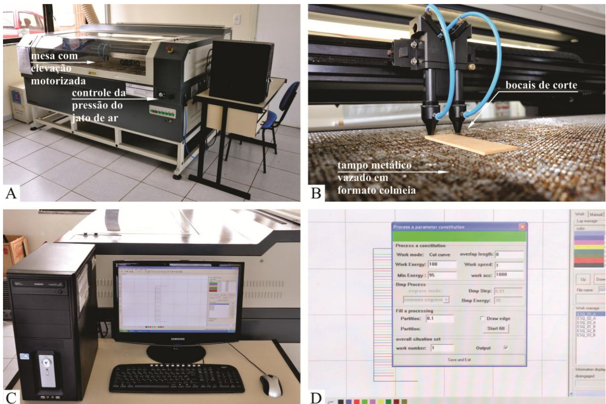
(A) Vista geral; (B) Detalhe dos bocais de corte; (C) Computador para manipulação dos desenhos e parâmetros; (D) Janela de ajuste dos parâmetros potência, velocidade e aceleração.
