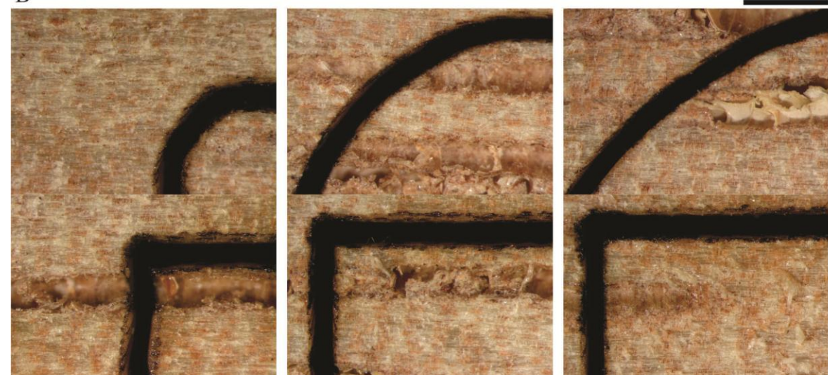
(A) Da esquerda para direita, amostras nas espessuras 5, 4, 3, 2 e 1 mm; (B) Imagens de microestereoscopia das amostras de 5 mm; (C) Imagens de microestereoscopia das amostras de 4 mm; (D) Imagens de microestereoscopia das amostras de 3 mm; (E) Imagens de microestereoscopia das amostras de 2 mm; (F) Imagens de microestereoscopia das amostras de 1 mm. Da esquerda para direita, formas com 2, 6 e 10 mm; acima círculos e abaixo, quadrados.
