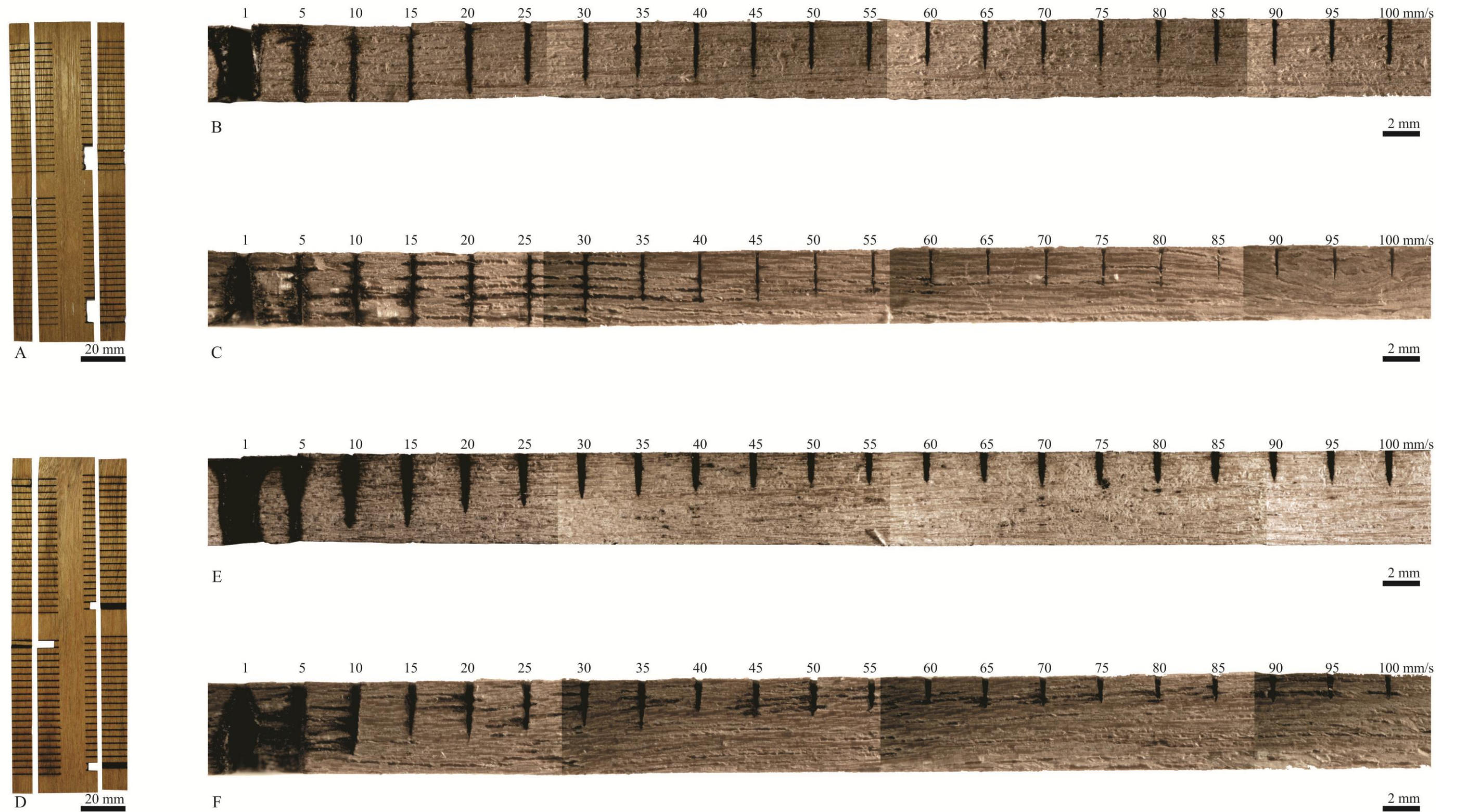
Figura 43 – Louro amazonense: ensaio com traços retos em amostras de 4 mm e 5 mm.
