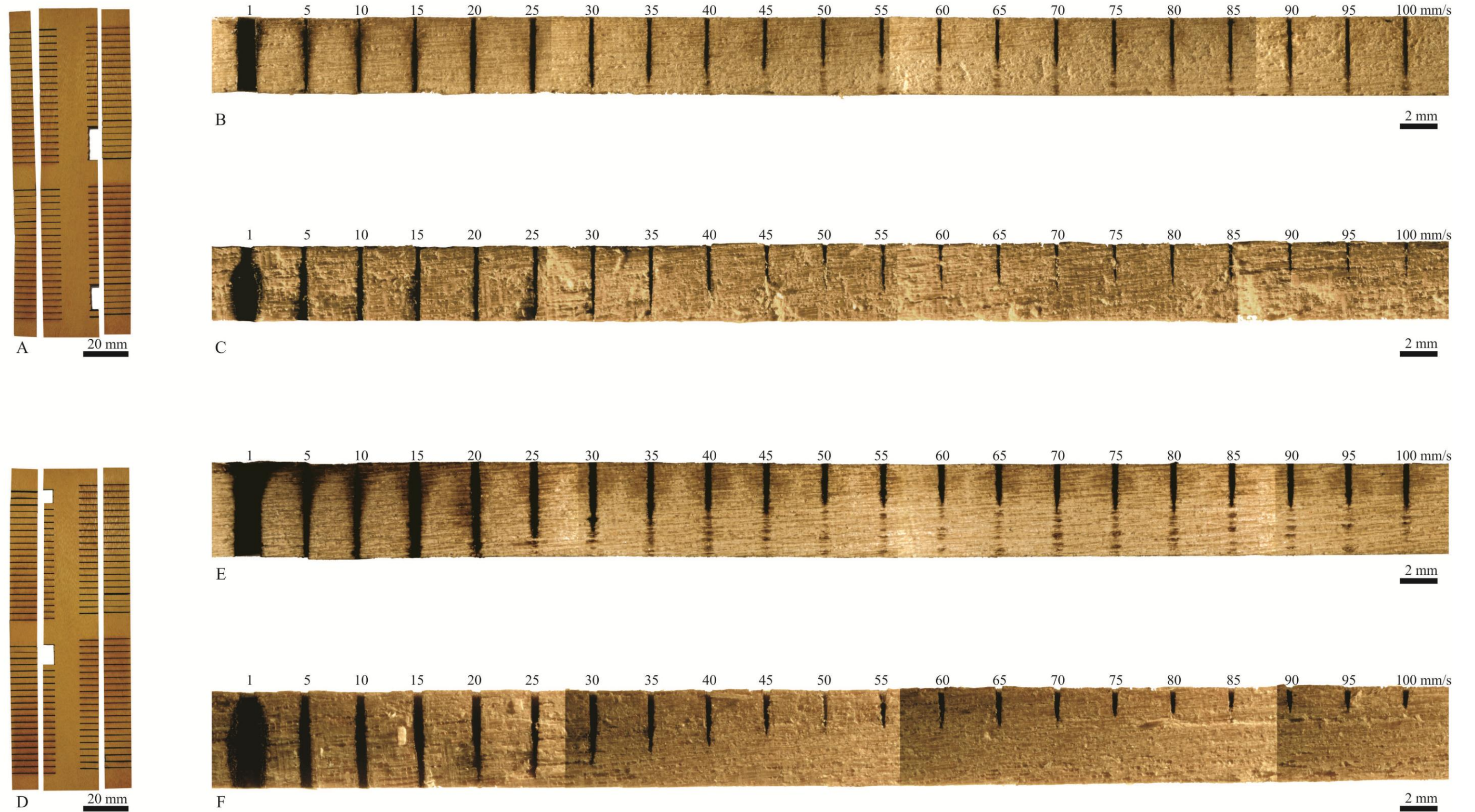
Figura 41 – Garapeira: ensaio com traços retos em amostras de 4 mm e 5 mm.
