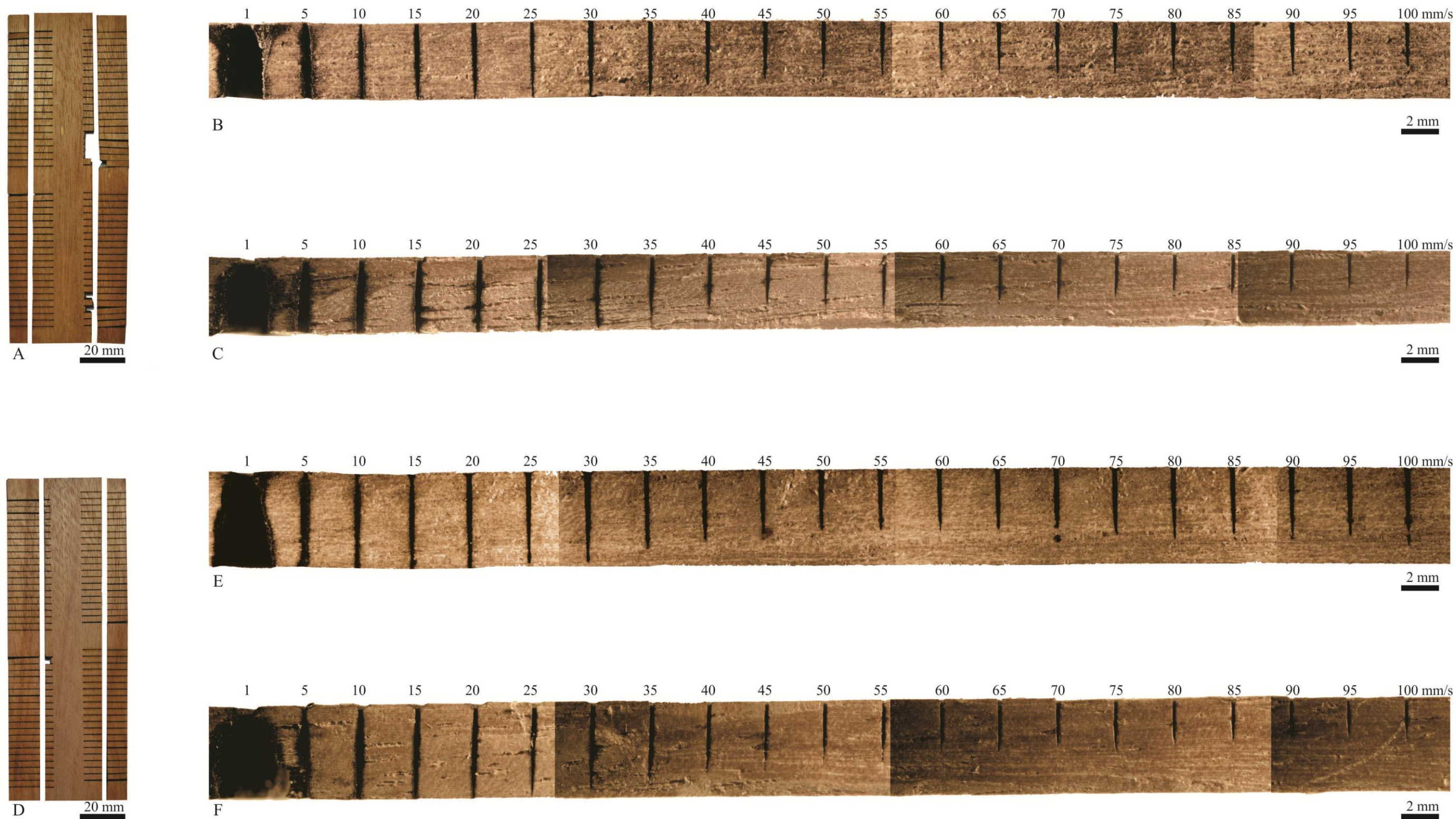
Figura 44 – Tauari: ensaio com traços retos em amostras de 4 mm e 5 mm.
