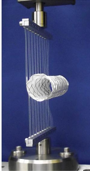
Figura 38: Fotografia de uma endoprótese durante o ensaio de força radial.
