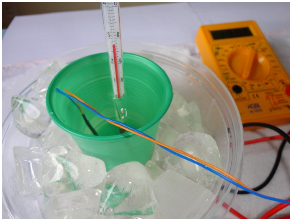
Figura 22: Termômetro no centro do copo e sensor no fundo do mesmo Fonte: Arquivos do autor
