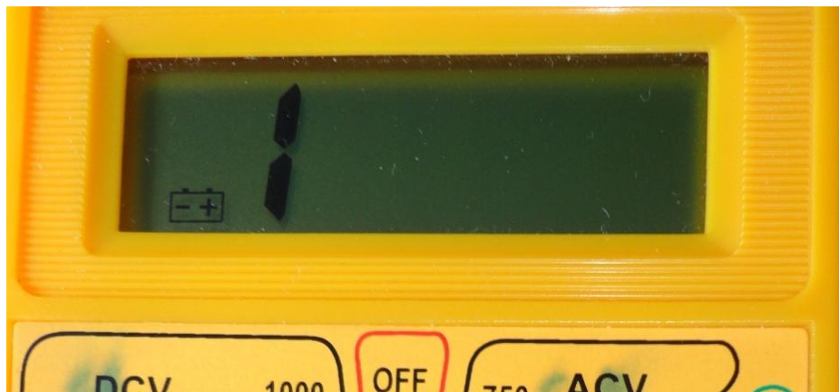
Figura 12: Display do Multímetro no momento em que a escala utilizada para aferir a resistência elétrica é menor que a resistência do sensor Fonte: Arquivos do autor
