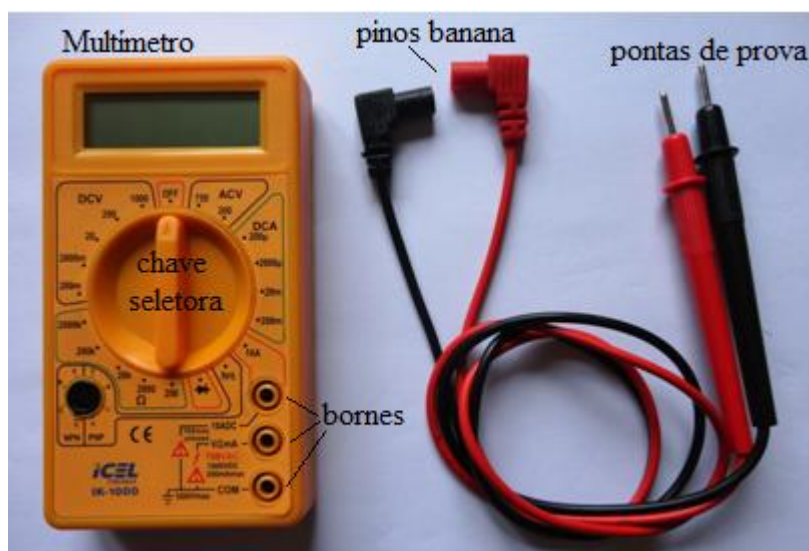
Figura 11: Multímetro modelo ICCEL Manaus IK-1000 e seus elementos Fonte: Arquivos do autor
