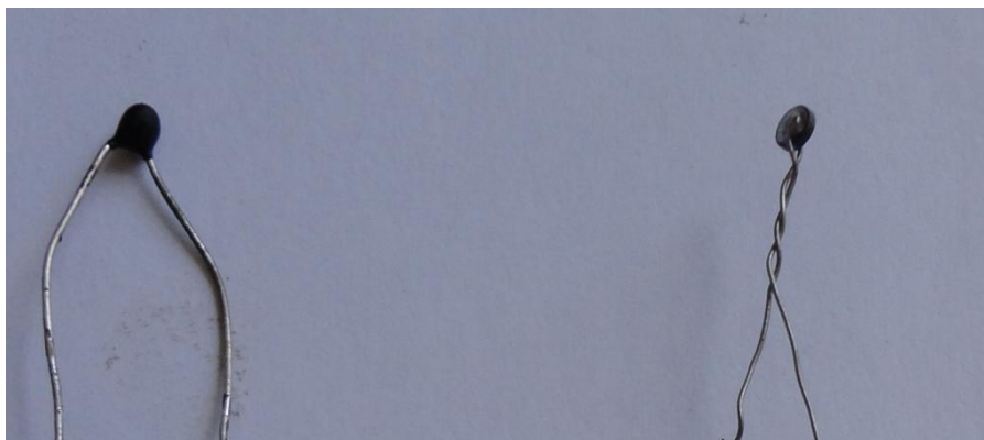
Figura 14: Diferença entre o sensor de 10k\Omega (com capa epóxi preta) e o sensor de 5k\Omega (sem capa epóxi) em que seus terminais foram enrolados
