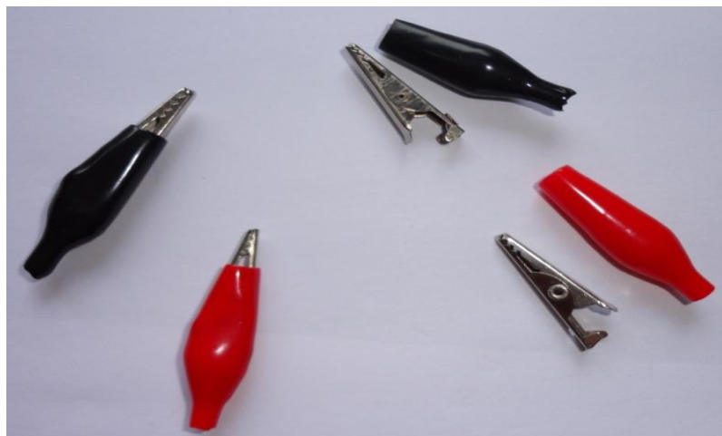
Figura 16: Não há diferença entre as garras jacaré preta ou vermelha Fonte: Arquivos do autor
