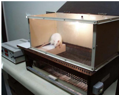
Figura 2. Aparelho de EsQUIVA INIBITÓRIA, conectado à fonte elétrica (0,4mA, 2 s), para avaliação da memória de longa duração (24 horas) em ratos.
