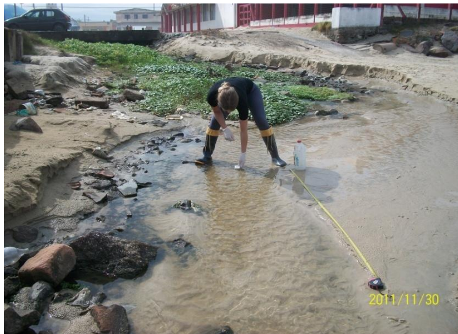
Figura 5. Coleta de dados para realização do perfil batimétrico, realizada no mês de novembro/11, no Ponto 1.
