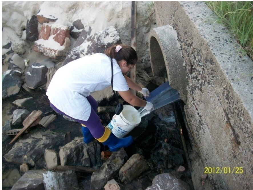
Figura 6. Determinação da vazão sendo realizada no Ponto 2. Observe a “base de acrílico”, que serve de auxílio no direcionamento da água. Coleta do mês de janeiro/12.
