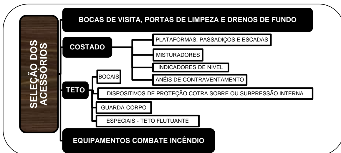
Figura 4.4 – Gráfico esquemático da quarta etapa da metodologia de projeto para tanques de armazenamento de petróleo e seus derivados.
