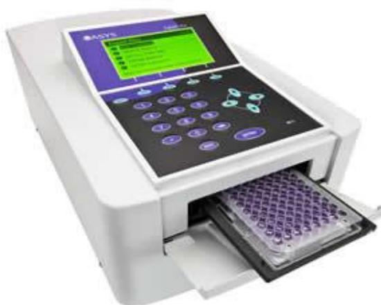
**Figura 4.** Equipamento para análise colorimétrica ELISA
