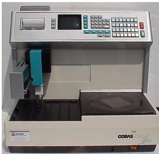
**Figura 5.** Multianalisador bioquímico COBAS Mira Plus
