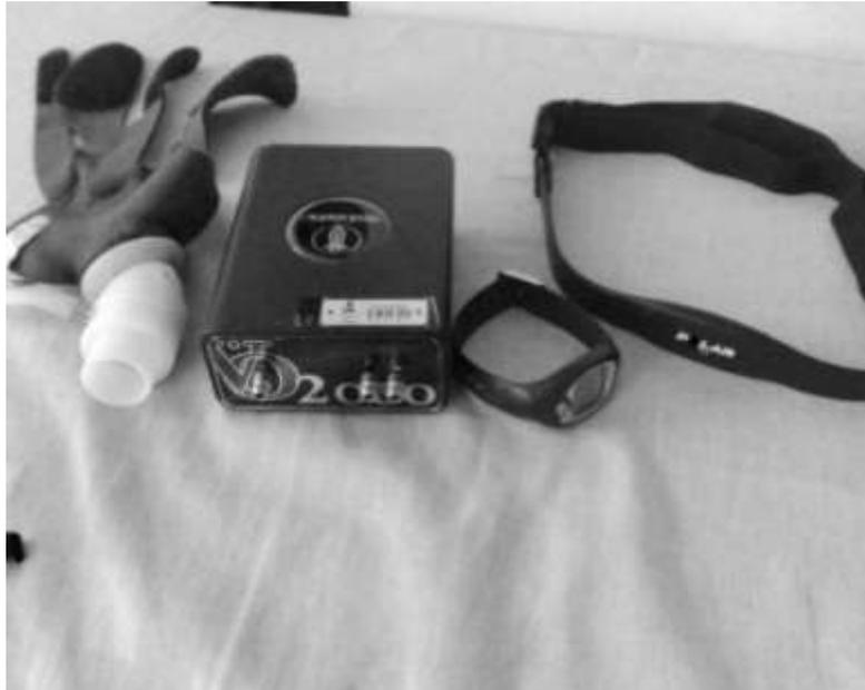
Figura 8 – Analisador de gases portátil e equipamentos utilizados no teste incremental.
