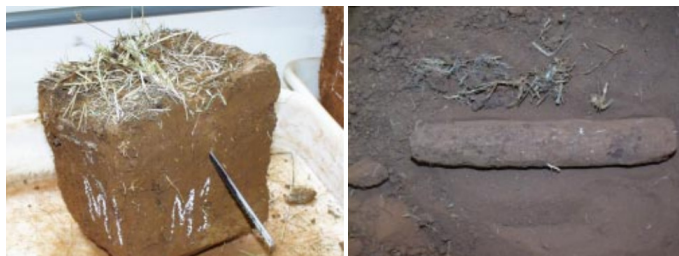
Figura 4.1: Corte e raspagem do bloco de solo para retirada de amostra cilíndrica (NAIME, 2001).
