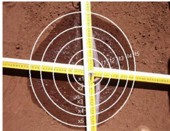
Figura 2.7: Detalhe do avanço da frente de molhamento em função do tempo (SOUZA, 2011).
