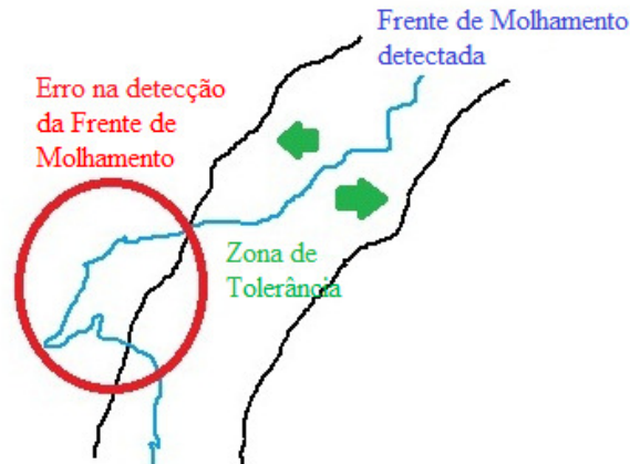
Figura 4.4: Zona de tolerância definida como uma aproximação do groundtruth para medir a proporção de erro na detecção da frente de molhamento com o método proposto (VÁSQUEZ et al., 2013).
