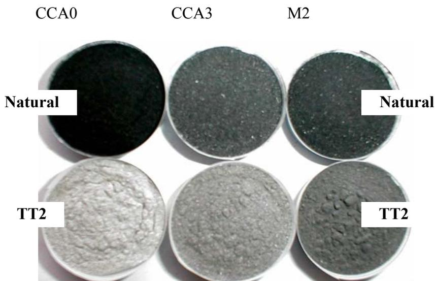
FIGURA 4.24 Amostras de cinzas e misturas com e sem tratamento TT2
