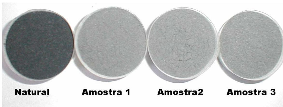
FIGURA 4.37 Amostras de CCA0 submetidas a banhos químicos com diferentes concentrações de HCl
