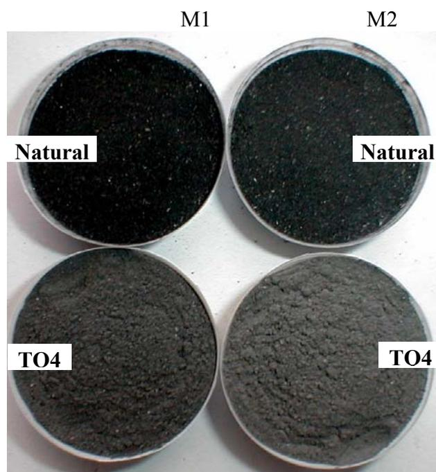
FIGURA 4.32 Misturas de cinzas residuais, M1 e M2, tratadas com TQ4 (solução NaOH)
