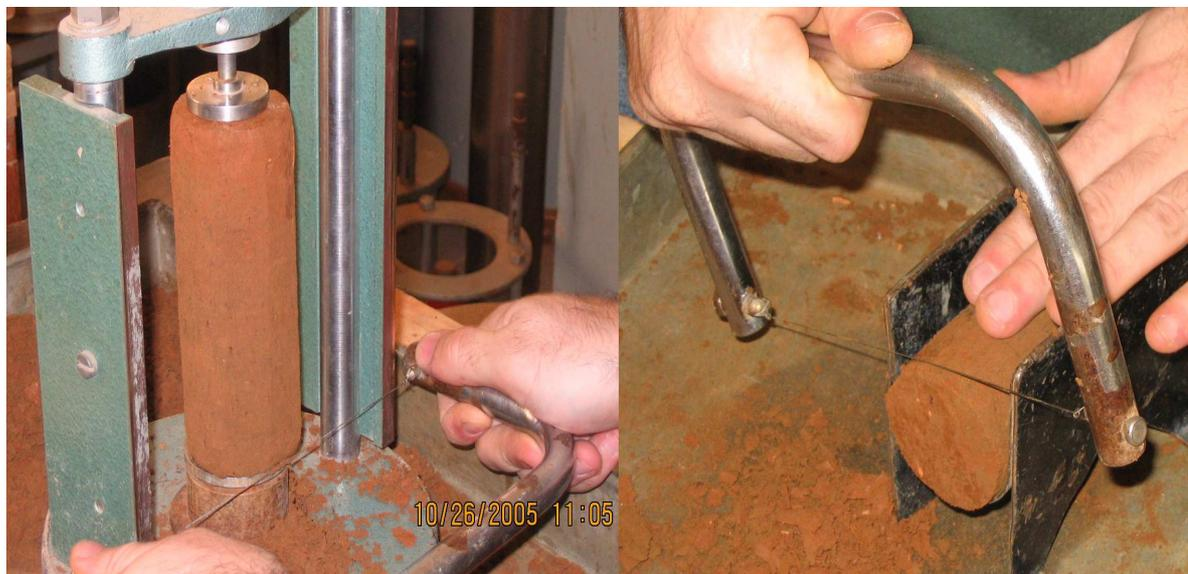
**Figura 4.4 –Moldagem dos corpos de prova indeformados.**
