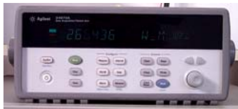
Figura 4.14 Ilustração da vista frontal do instrumento usado para aquisição de dados marca HP modelo 34970 A.
