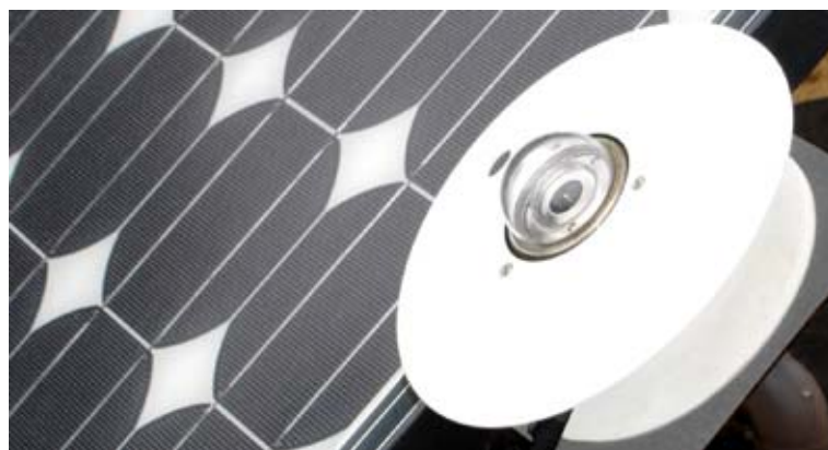
Figura 4.13 Ilustração do piranômetro EPPLEY modelo PSP instalado junto aos arranjos fotovoltaicos.
