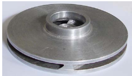
Figura 4.8 Desenho mostrando em detalhe as pás do impelidor e ilustração do impelidor plano fechado usado nesse trabalho.
