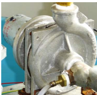
Figura 4.7 Ilustração do conjunto motor e bomba centrífuga.
