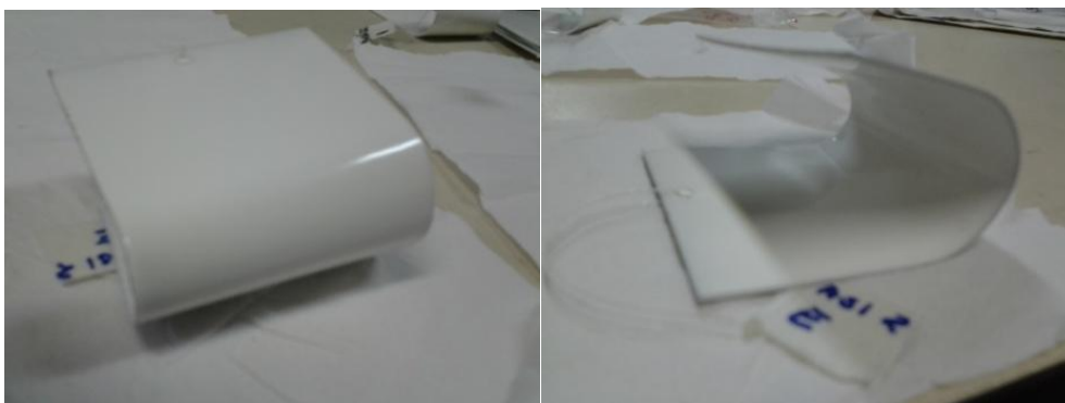
Figura 33. Ensaio de flexão para a TASI 2.
