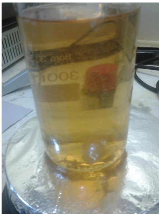
Figura 9. Solução de tanino com silano após preparo.
