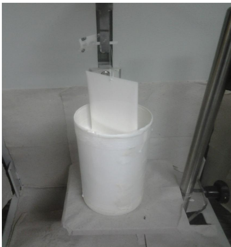
Figura 10. Pintura das peças por imersão.
