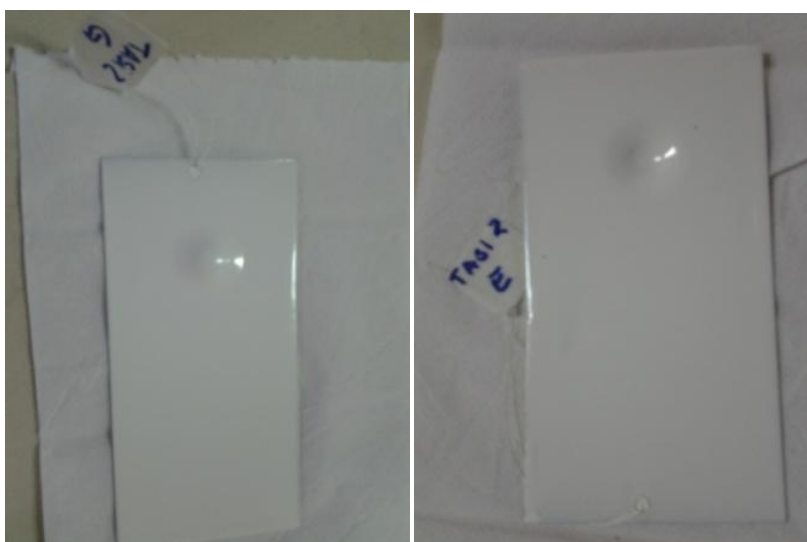
Figura 32. Ensaio de impacto para a TASI 2.
