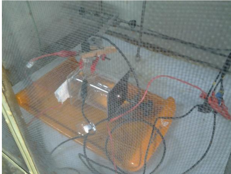
Figura 11. Célula montada para a realização do ensaio eletroquímico.
