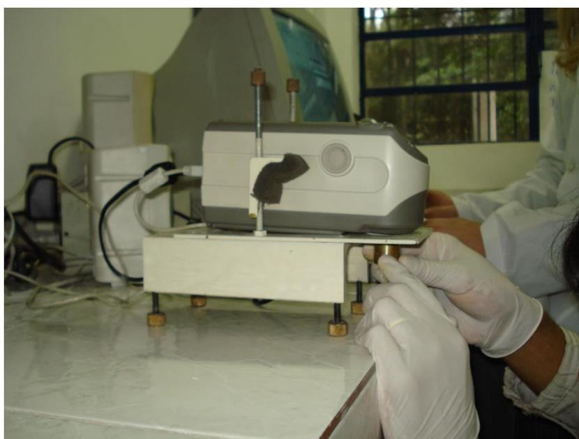
Figura 15: Colorímetro empregado para medir cor nas amostras de resíduo (CIAC) e de pigmentos padrões a base de  $\text{Cr}_2\text{O}_3$  através das coordenadas  $L^*$   $a^*$   $b^*$  (MARCELLO, 2008).
