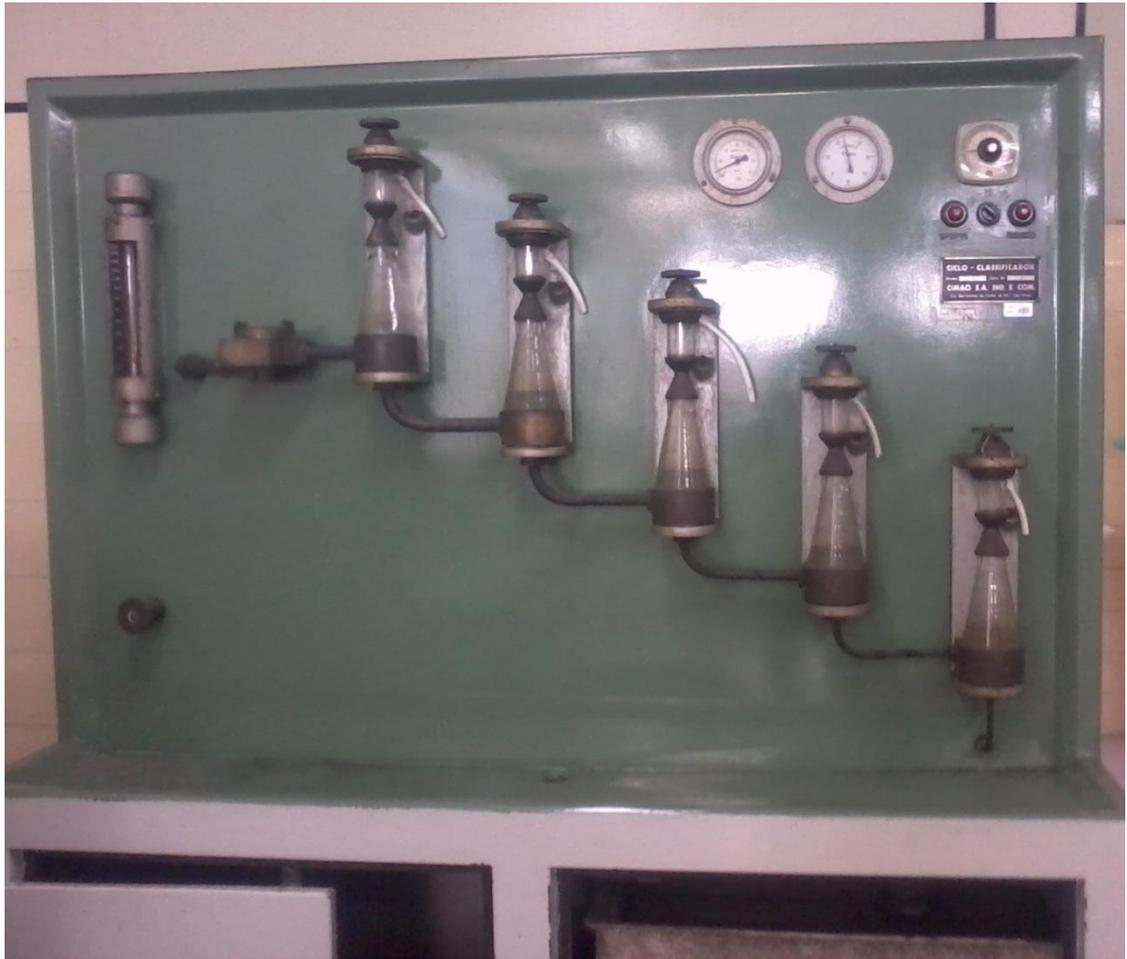
Figura 17: Equipamento cicloclassificador da marca CIMAQ utilizado na separação granulométrica do resíduo (MARCELLO, 2008).
