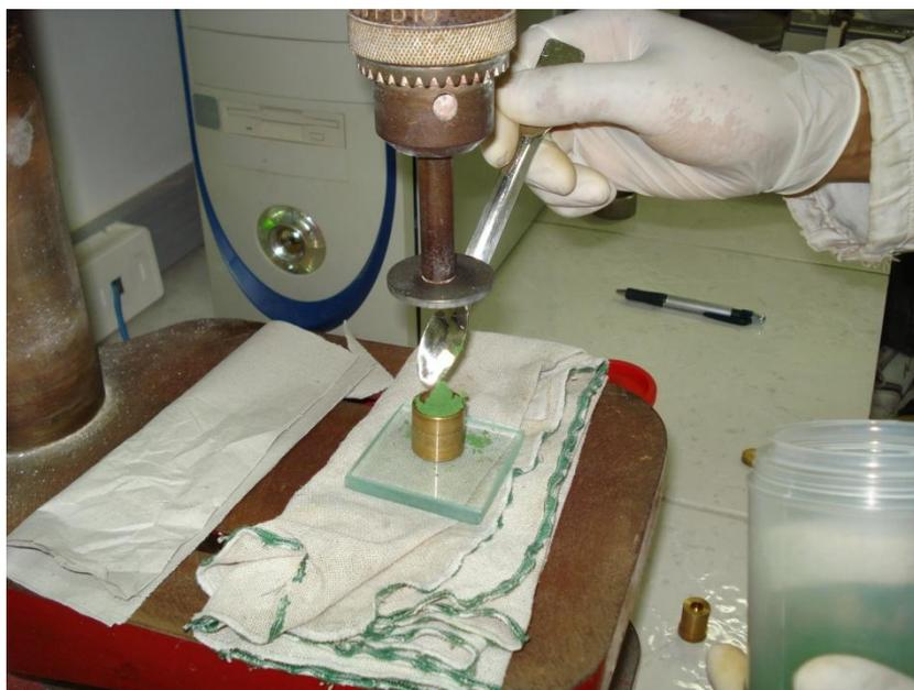
Figura 14: Prensa mecânica utilizada para a obtenção das pastilhas empregadas para medir cor nas amostras de resíduo (CIAC) e de pigmentos padrões a base de  $\text{Cr}_2\text{O}_3$  (MARCELLO, 2008).
