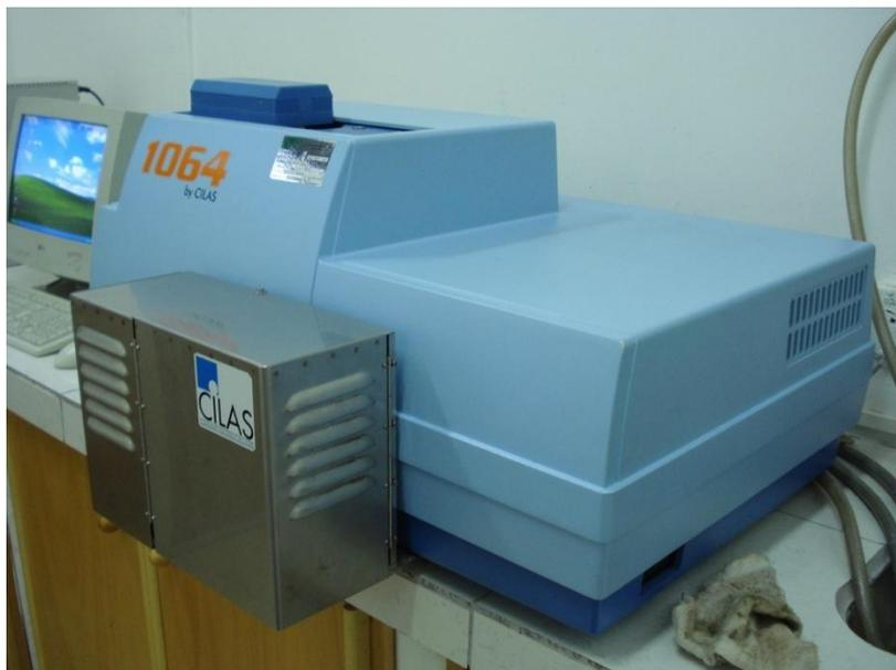
Figura 12: Granulômetro da marca CILAS 1064 Líquido na faixa entre 0,04  $\mu\text{m}$  – 500.00  $\mu\text{m}$  /100 classes. (MARCELLO, 2008).
