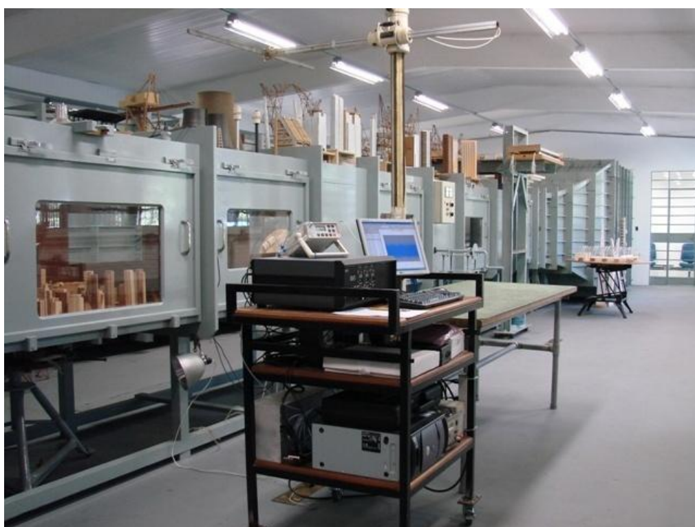
Figura 4.1 – Vista lateral do Túnel de Vento Prof o Joaquim Blessmann. [LAC, 2010]
