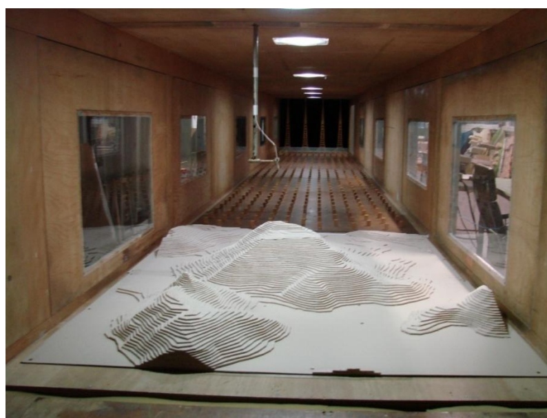
Figura 4.2 – Modelo morro Jaburu fixado no túnel de vento [LAC, 2010]
