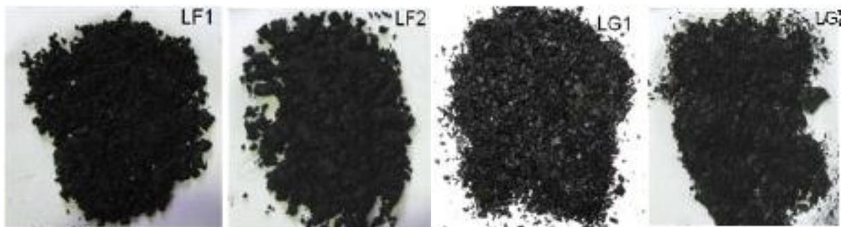
Figura 35 - Comparação da morfologia das carepas grossas da laminação 1 e 2 (LG) e carepas finas da laminação 1 e 2 (LF).
