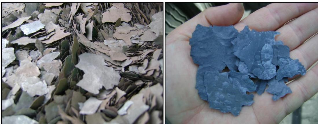
Figura 14 – Carepa de lingotamento contínuo e seu detalhe à direita.
