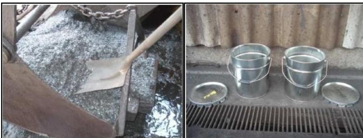
Figura 25 - Ilustração do procedimento de coleta de amostras de carepas.
