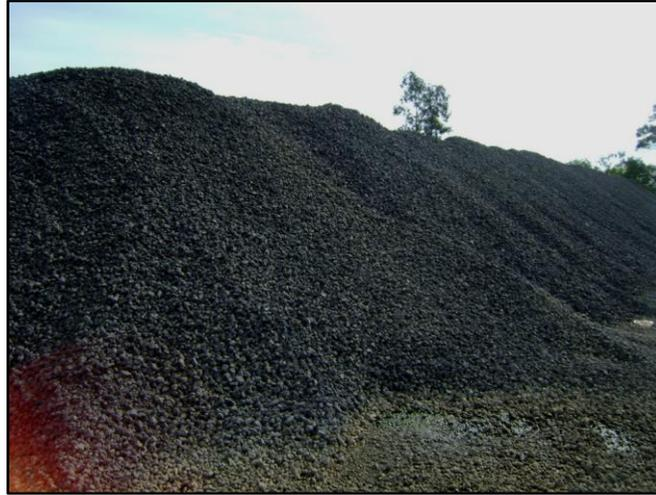
Figura 13 – Pilha de agregado siderúrgico estocado aguardando período de estabilização.
