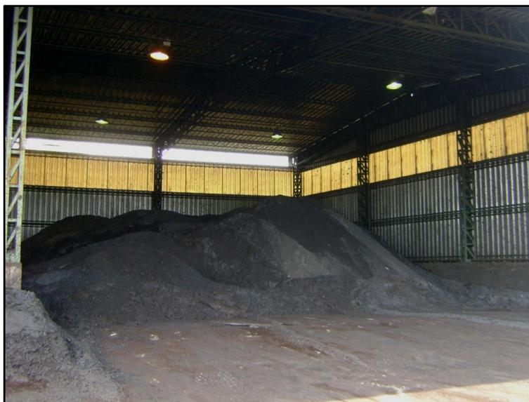
Figura 15 – Carepa estocada sob galpão impermeabilizado.
