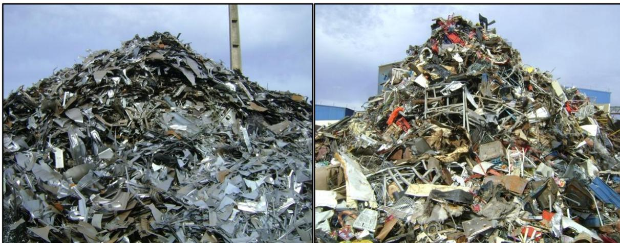
Figura 5 – Pilhas de sucata para consumo em forno elétrico a arco.
