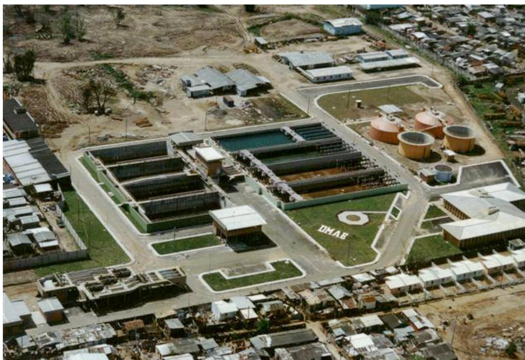
**FIGURA 4.** Vista aérea da estação de tratamento de esgoto ETE São João – Navegantes. Ao fundo, à direita, tanques de aeração, local de coletas das amostras. Fonte: DMAE, 2012. <http://www2.portoalegre.rs.gov.br/dmae/default.php>.
