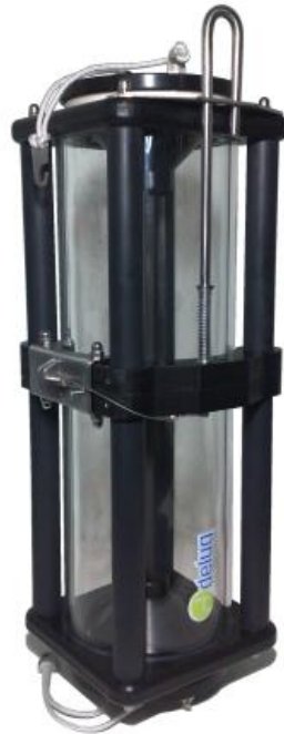
Figura 7- Foto ilustrativa da Garrafa de Niskin utilizada nas coletas de amostra de água.
