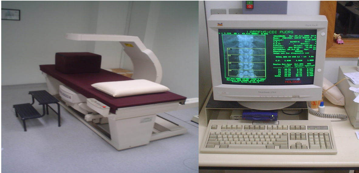
Figura 3 - Aparelho densitômetro de dupla emissão de raios x, tipo DXA (QDR 4500 A Hologic Inc. Boston USA).
