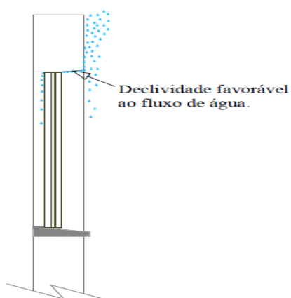
Figura 29 – Mecanismo de infiltração na interface janela/verga
