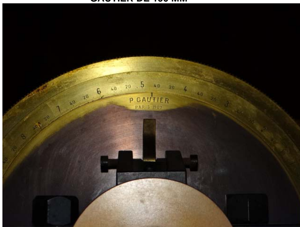
FIGURA 3 - CÍRCULO HORÁRIO DO TELESCÓPIO REFRACTOR EQUATORIAL GAUTIER DE 190 MM
