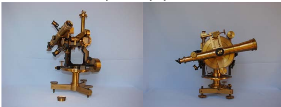
FIGURA 6 - TEODOLITO MAGNÉTICO CHASSELON E LUNETAS MERIDIANA PORTÁTIL GAUTIER
