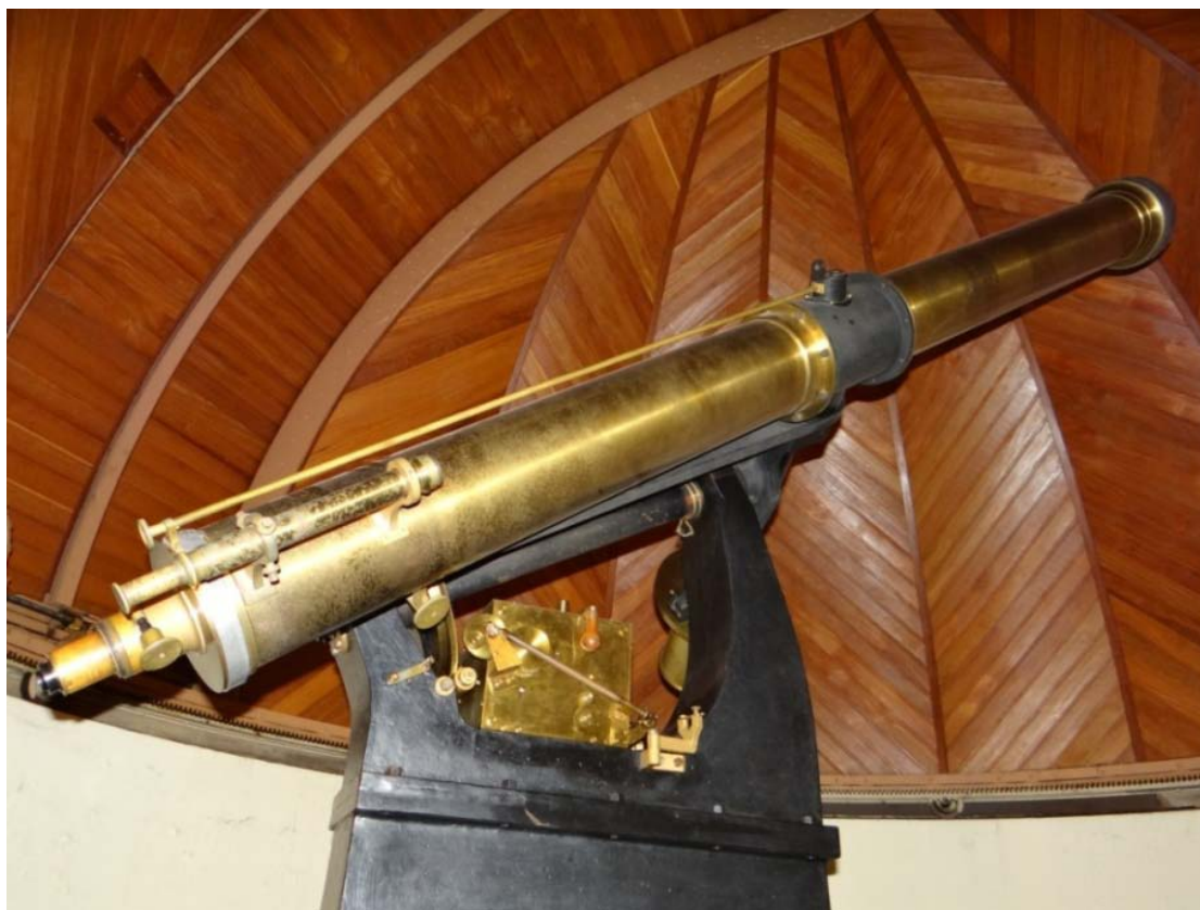
FIGURA 2 - TELESCÓPIO REFRATOR GAUTIER DE 190 MM
