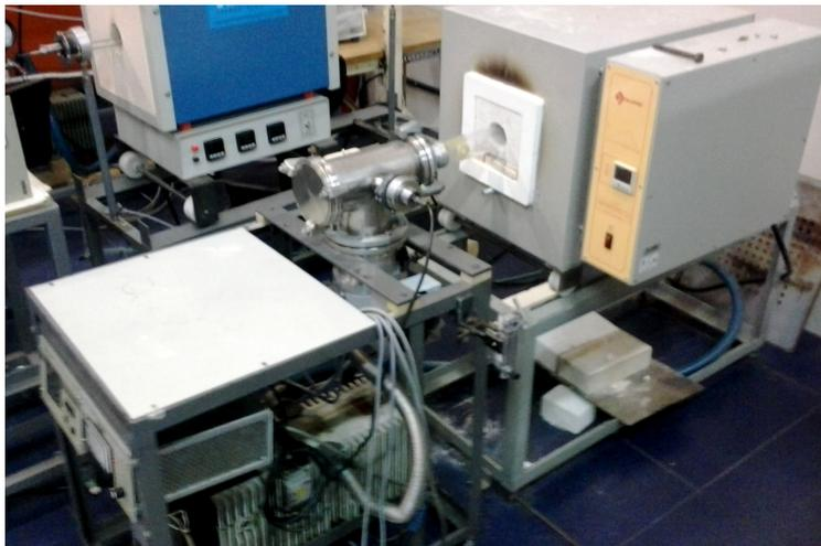
Figura 4.15: Foto do forno e do sistema de vácuo utilizados para tratamento térmico dos nanocristais. À direita, uma ilustração da amostra dentro do forno.
