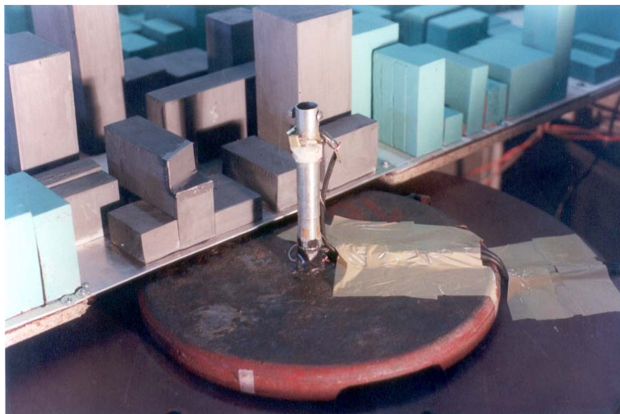
Fig. 6.4: Balança com extensômetro para medir os momentos.
