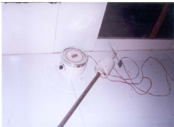
Fig. 5.12: Cata-vento de medição da direção do escoamento médio
