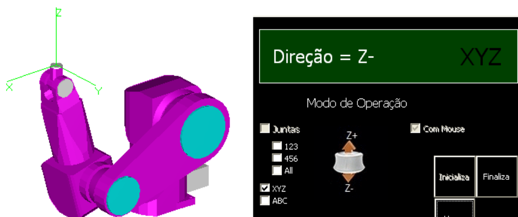
Figura 52 - Teste realizado na direção do eixo -Z , modo linear
