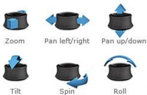
Figura 27 - Aplicação típica de um mouse 3D
