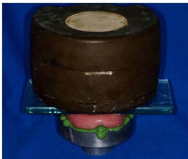
Figura 9 - Base desgastada, do grupo teste, utilizada como moldeira para a nova impressão do modelo metálico sob carga de 2kg
