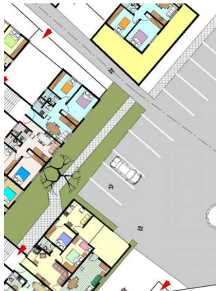
Figura 44 Núcleo com o cul-de-sac do projeto de Regularização Fundiária executado, porém com forma retangular e não em losango, conforme o previsto. Fonte: Desenho e levantamento de Sabrina Motta sob orientação do Prof. Dr. Douglas Aguiar
