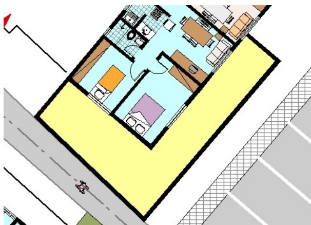
Figura 119 Construção de muros e privatização de área no apartamento térreo para proporcionar privacidade. Fonte: Desenho e levantamento de Sabrina Motta com orientação do Prof. Dr. Douglas Aguiar
