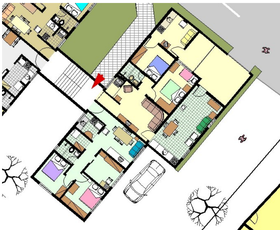
Figura 118 Aumento do apartamento tipo B no pavimento térreo. Apartamento ampliado e transformado em dois. É exatamente a área de cozinha e estar, subdimensionada no projeto original, que é criada. Fonte: Desenho e levantamento de Sabrina Motta com orientação do Prof. Dr. Douglas Aguiar
