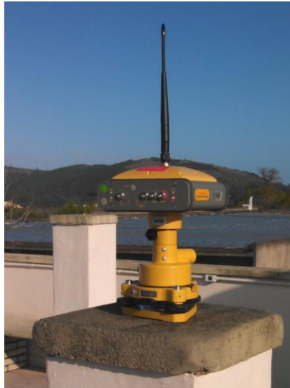
Figura 3-3: Receptor GNSS instalado na Estação Passiva REGPS/RS no prédio do Departamento de Astrofísica. Fonte: Arquivo Pessoal
