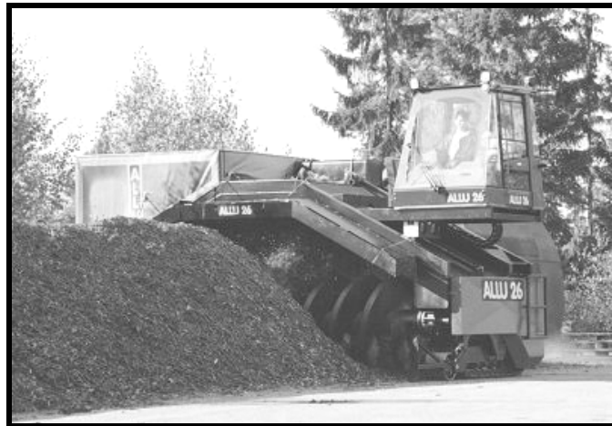
FIGURA 13 - equipamento revirando a leira de RSU em compostagem do tipo windrow .
