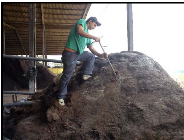
FIGURA 63 – Amostragem a trado na leira experimental com ponteiras horizontais proposta.
