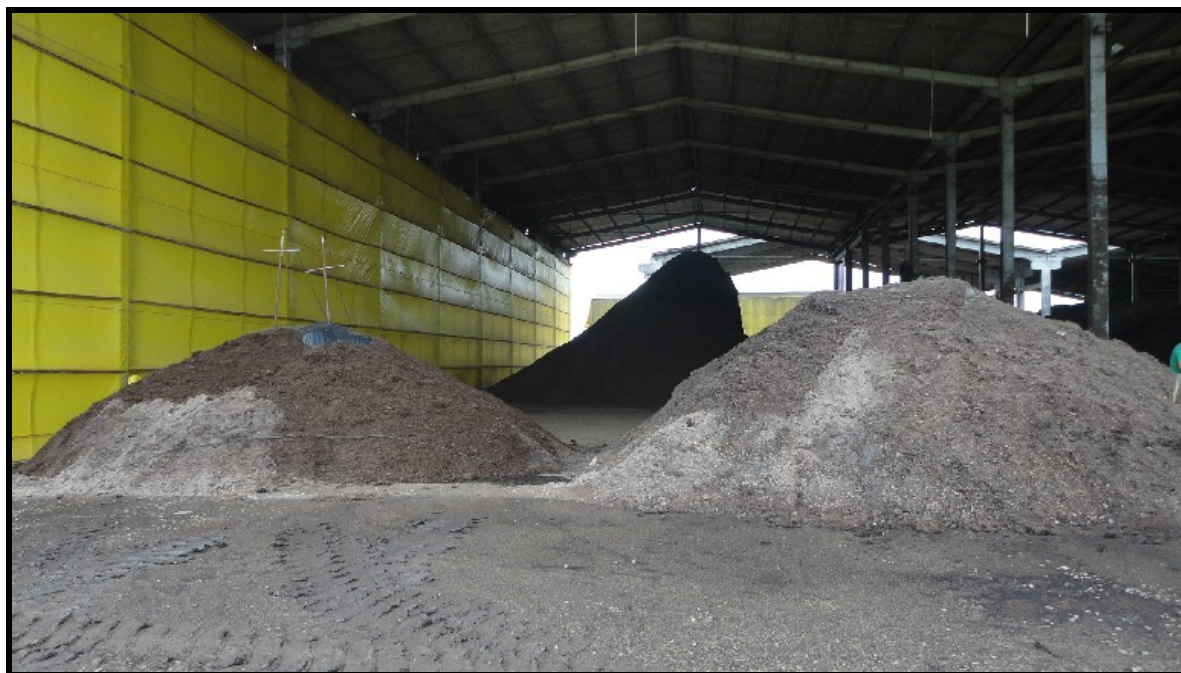
FIGURA 56 – Leira com ponteiras verticais à esquerda, e leira experimental com ponteiras horizontais com método de aeração proposto a direita.
