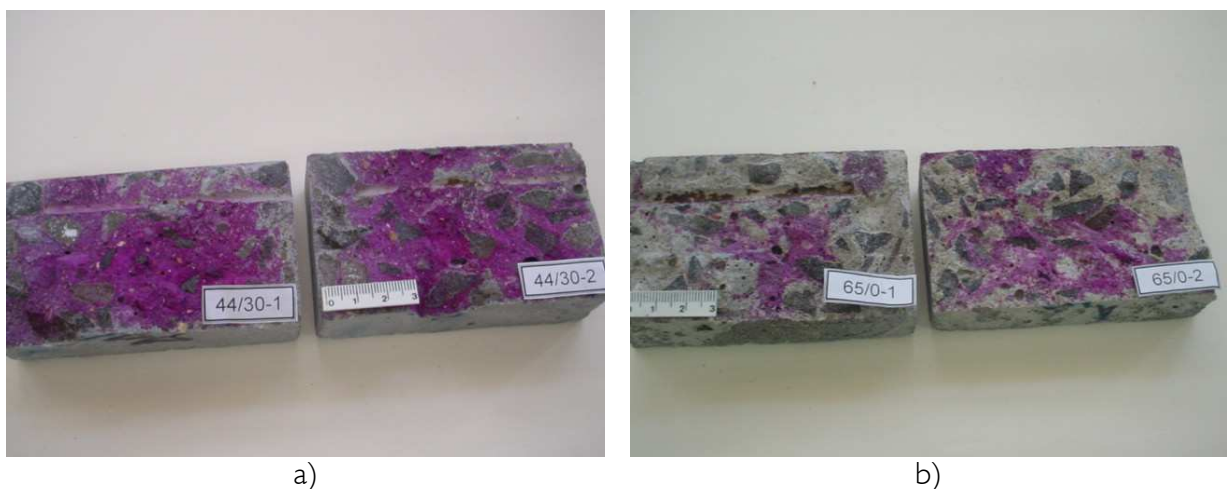
Figura 25: Corpos-de-prova utilizados nos ensaios eletroquímicos, carbonatados por 223 dias em 5% de \text{CO}_2 (1) e em mais de 50% \text{CO}_2 (2): a) a/agl 0,44 com 30% de cinza volante e b) a/agl 0,65, sem cinza volante.
