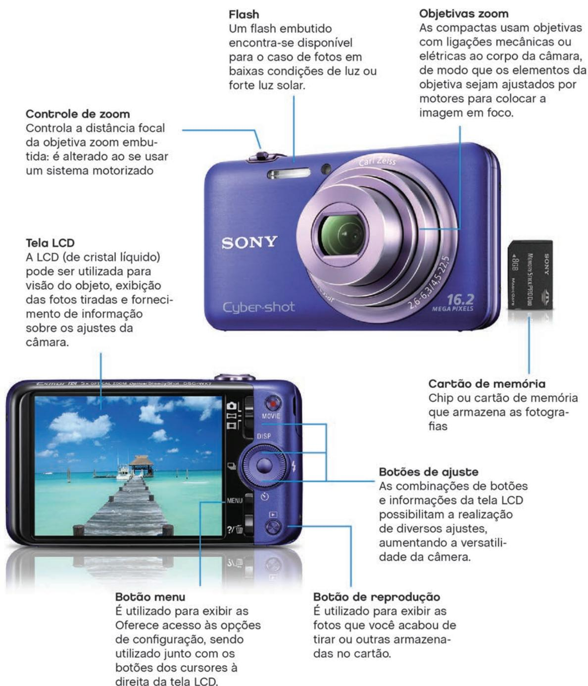
Figura 18: Esquema da câmera digital
