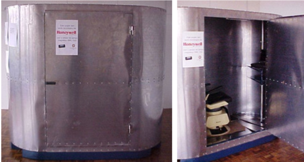
Figura 8: Ambiente com conceito de Gaiola de Faraday desenvolvido no Laboratório de Biosinais UCS_CARVI Fonte: Spindola (2010)
