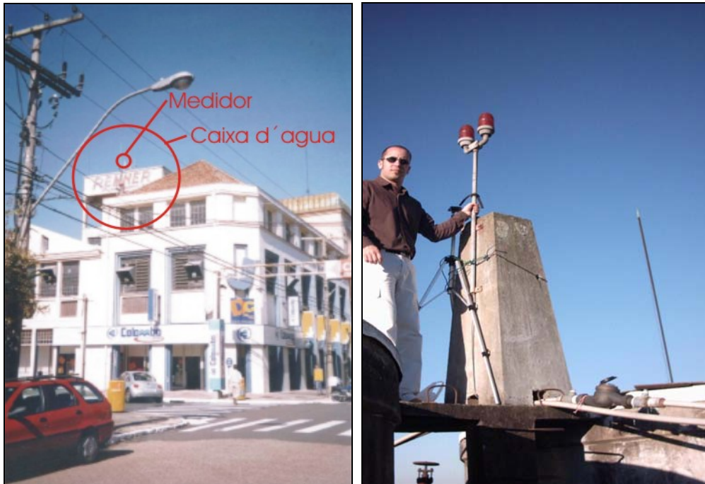
Figura 16. Caixa de água (foto à esquerda) e posicionamento do sonômetro sobre a mesma (foto à direita)
