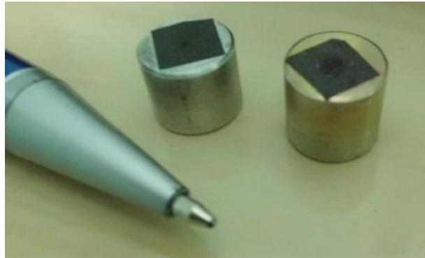
Figura 38: Porta amostras “stubs” utilizados nos ensaios.
