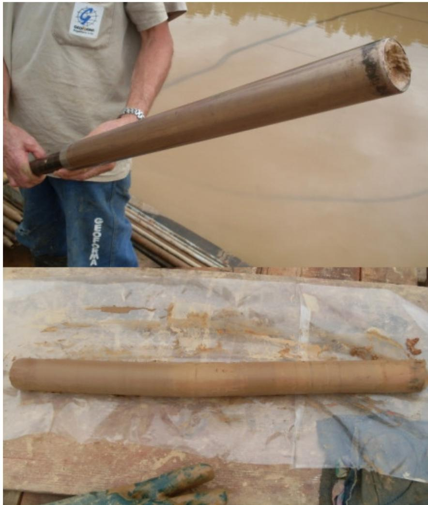
Figura 25: Coleta de amostras de Resíduo de Zinco (Amostrador *Shelby*).
