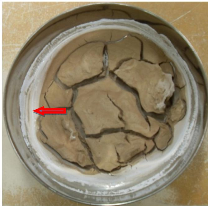
Figura 41: Amostra de resíduo após a secagem em estufa.
