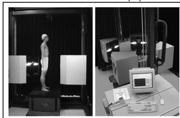
Figura 14 - Sistema de escaneamento de todo o corpo pelo scanner Vitus 3-D 1600.
