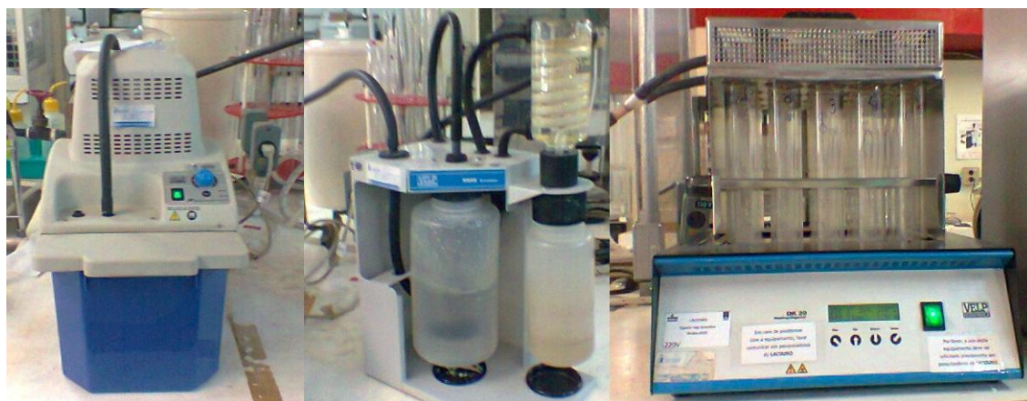
Figura 3.3: Análise de proteínas: lavador de gases acoplado ao digestor, onde os tubos foram acomodados.
