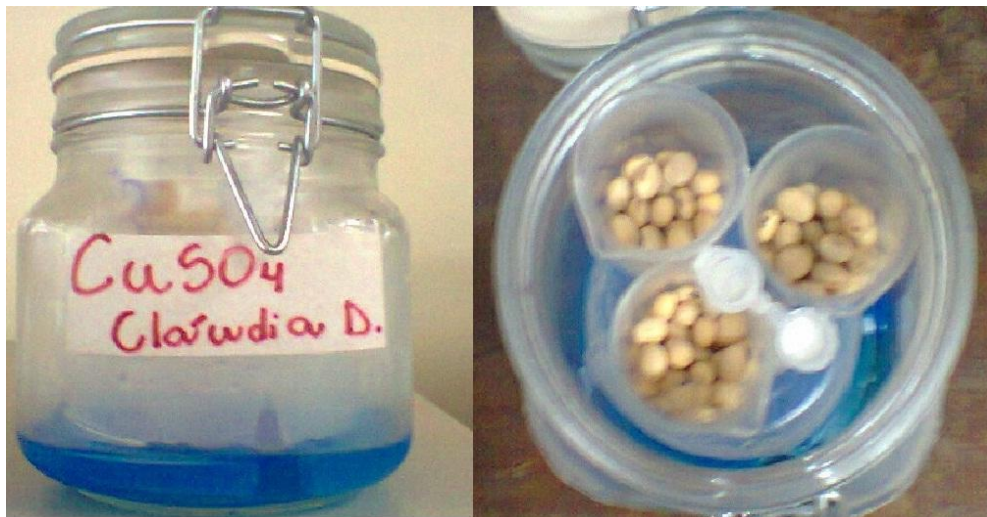
Figura 3.4: Frasco hermético contendo solução de sulfato de cobre II, utilizado nos experimentos de obtenção de isotermas de sorção para grãos de soja.
