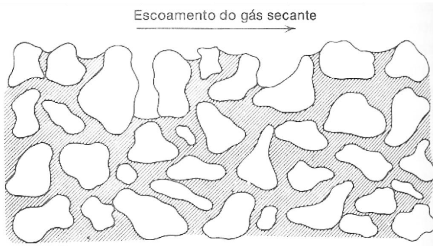
Figura 2.3: Distribuição da umidade no primeiro período de taxa decrescente em um leito sólido particulado (Foust et al. , 1982).
