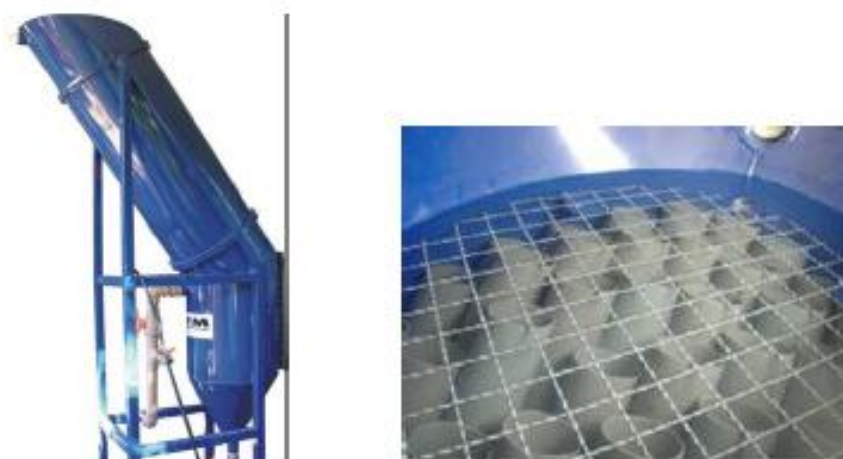
Figura 39. Equipamento de sedimentação lamelar utilizado na planta piloto. Detalhes construtivos na Tabela 10.
