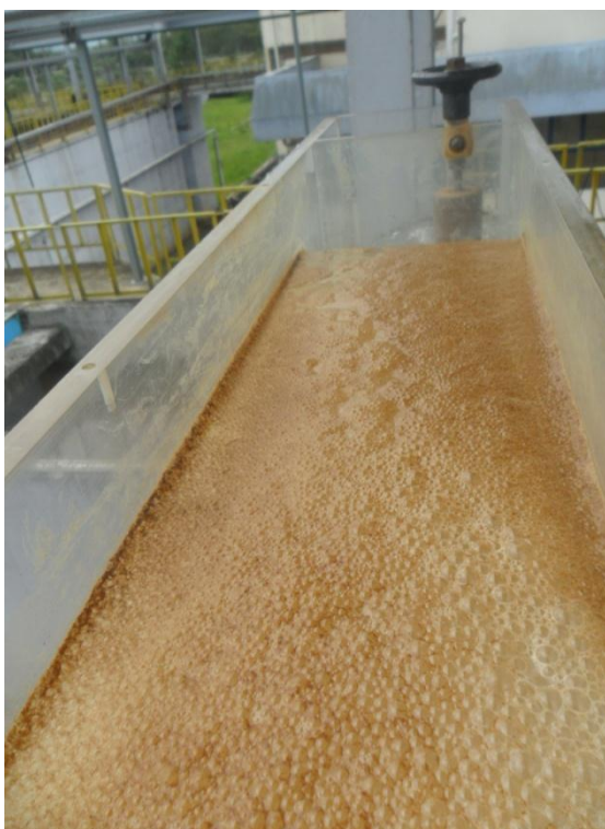
Figura 59. Fotografia da Flotação FAD-B em planta piloto. Sistema de escoamento de lodo flotado.
