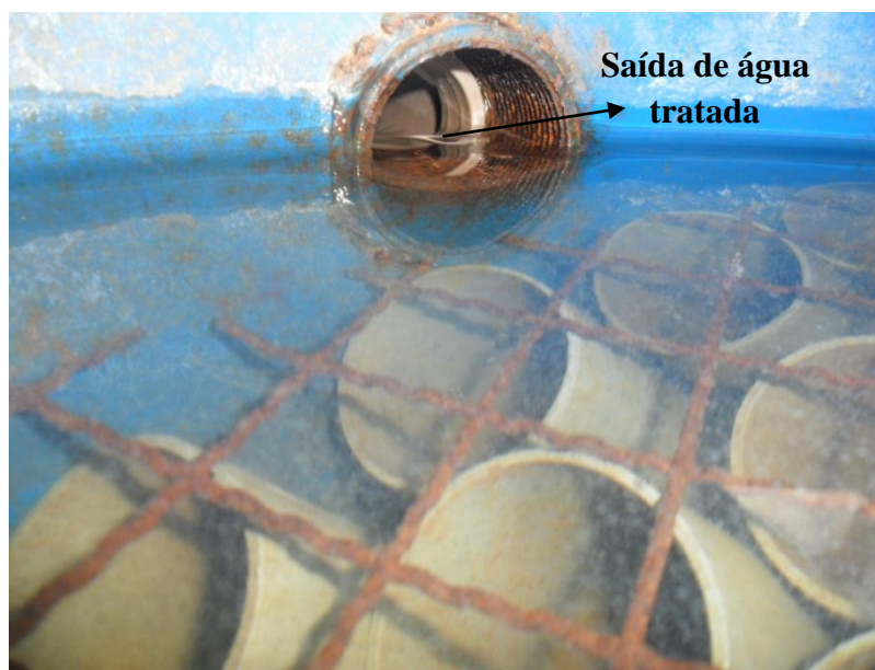
Figura 64. Fotografia da Sedimentação Lamelar – SL em planta piloto. Arraste de partículas na corrente de água tratada. Condições: Taxa de aplicação superficial = 4 \text{ m}^3 \cdot \text{m}^{-2} \cdot \text{h}^{-1} ; \text{pH} = 6.2 ; [\text{Al}_2(\text{SO}_4)_3] = 30 \text{ mg} \cdot \text{L}^{-1} ; G de mistura rápida = 1300 \text{ s}^{-1} , G de mistura lenta = 80 \text{ s}^{-1} .
