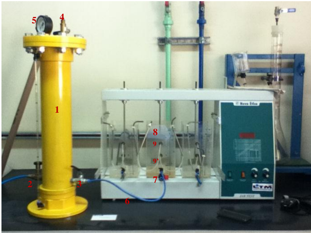
Figura 29. Sistema experimental de agregação-flotação de bancada usando um equipamento flotateste (Nova Etica ® ) acoplado a um vaso saturador de ar na água: 1) Vaso saturador; 2) Válvula gaveta (entrada de ar comprimido); 3) Válvula esfera (saída de água saturada); 4) Válvula de alívio de pressão com filtro de ar; 5) Manômetro; 6) Mangueira de diâmetro 4 mm; 7) Válvula agulha; 8) Célula flotateste; 9-9') ; Amostradores de água clarificada.
