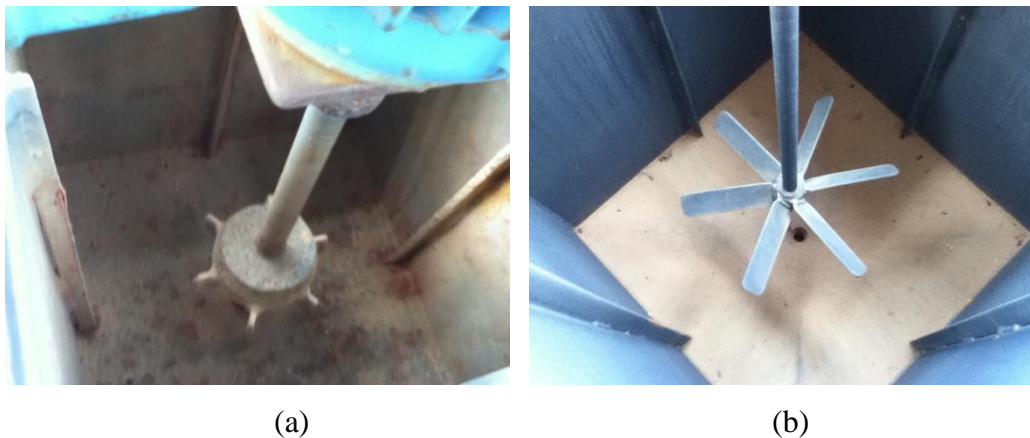
Figura 37. Fotografias das partes internas dos tanques de agitação mecanizada. (a) Tanque de mistura rápida com hélice de tipo fluxo radial; (b) Tanque de mistura lenta com hélice de tipo fluxo axial.
