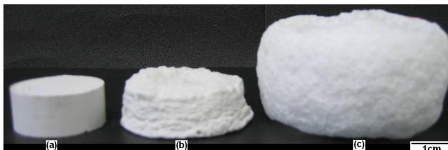
Figura 6.33. Corpos cerâmicos: (a) antes da queima; (b) depois da queima (relaxamento da expansão); (c) depois da queima (expansão máxima).
