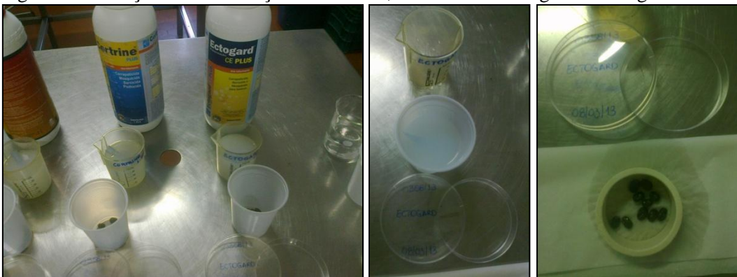
Figura 6 – Diluição das formulações acaricidas, imersão das teleóginas e secagem
