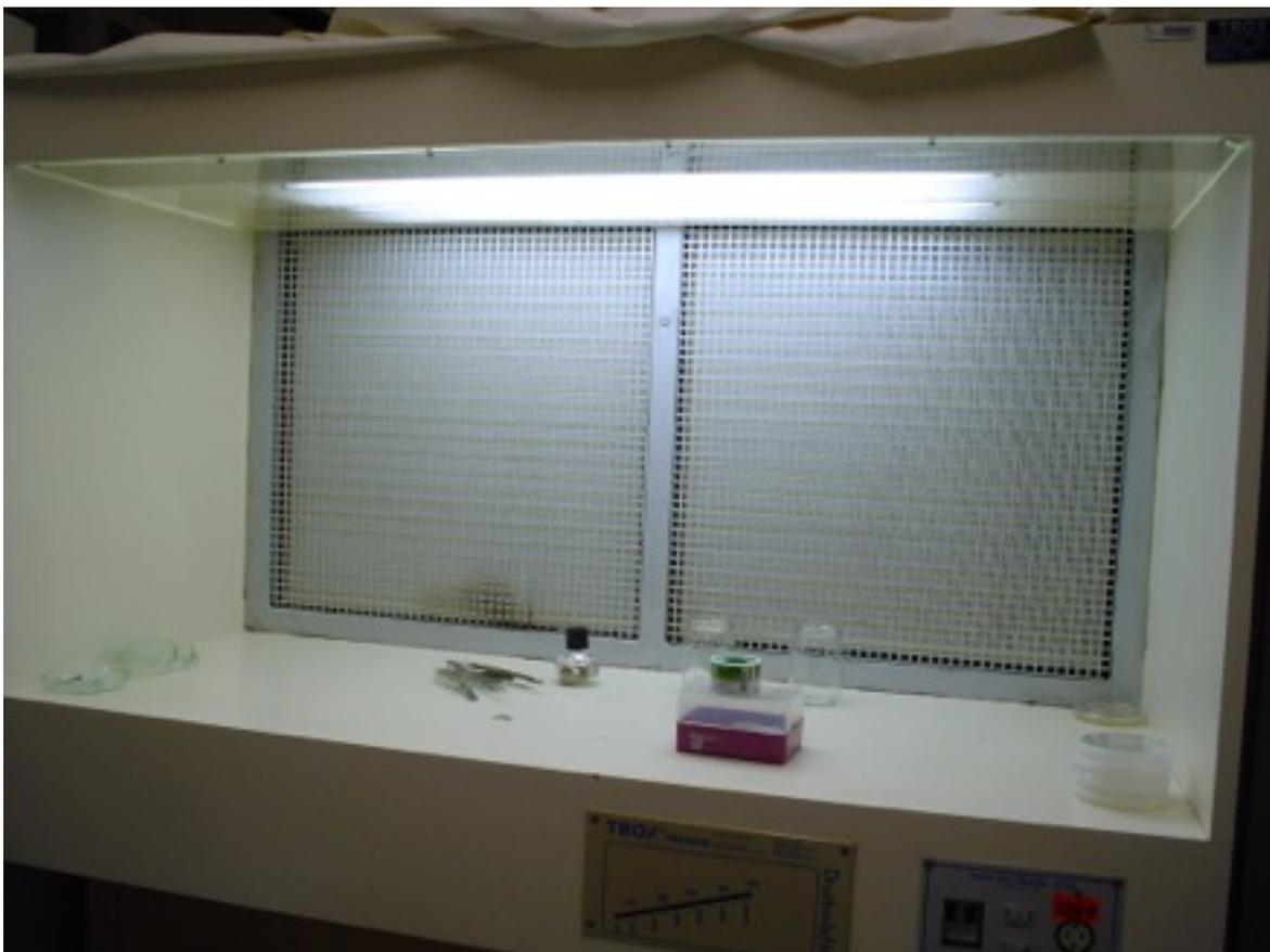
Figura 01 - Capela de Fluxo Laminar
